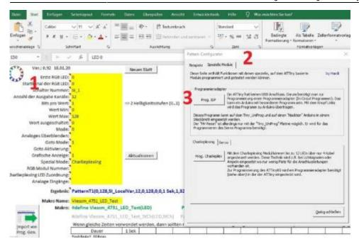
Anschließend wird vermutlich nach dem COM Anschluss des UNO gefragt. Wenn dieser definiert ist, wird der UNO für die Programmierung durch das Hochladen der entsprechenden .ino vorbereitet (C:\Users\MadMax\Documents\Arduino\libraries\MobaLedLib\examples\90.Tools\02.Tiny\_UniProg). Die Einstellung werden automatisch durch den Pattern\_Config. durchgeführt. Die LED auf dem UNO flackert. Wenn der UNO nur für diesen Zweck verwendet wird ist dieser Vorgang nur einmal durchzuführen.
