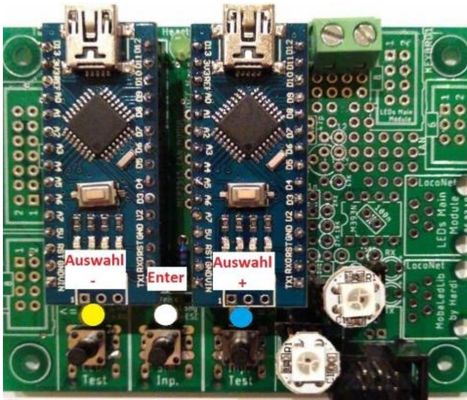
7. Mit der rechten(+) Taste (blaue LED) wählt man das entsprechende Servo aus. (In den meisten Fällen ist die LEDNr 0 die Heartbeat-LED). Im seriellen Monitor sieht man die ausgewählte LEDNr. und den RGB Kanal bzw. das ausgewählte Servo. Mit der linken(-) Taste (gelbe LED) kann man in der Auswahl zurück navigieren. \\Das ausgewählte Servo zuckt leicht hin und her. Anschließend mit der mittleren Taste bestätigen.
