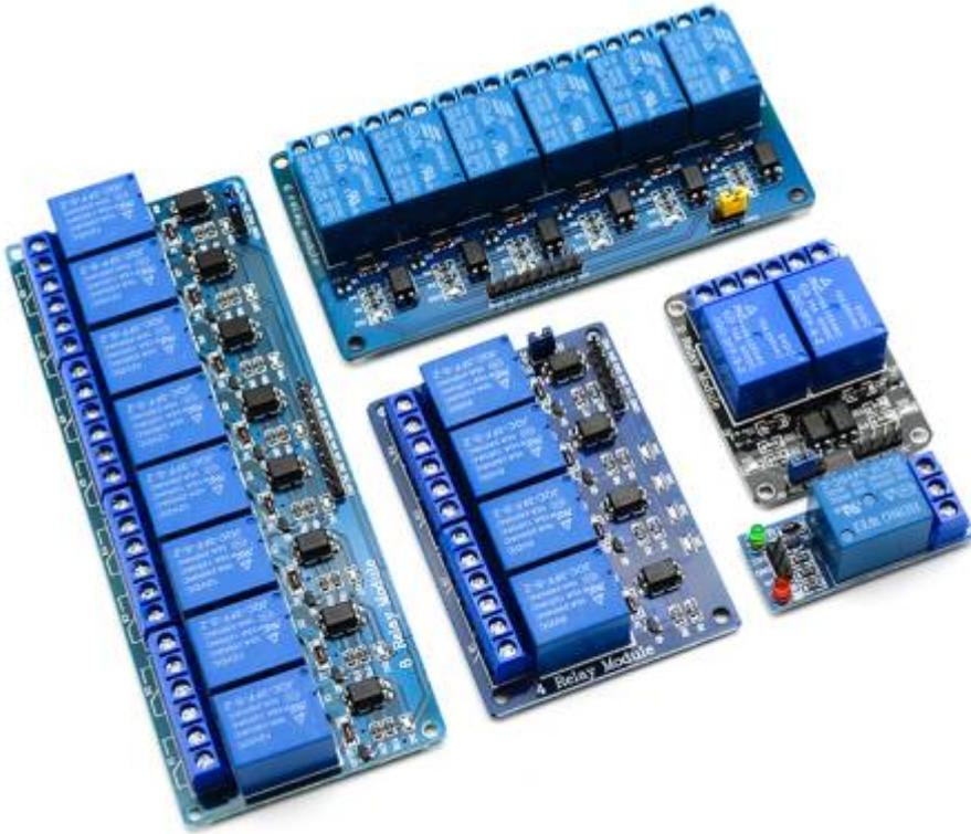
Die fertigen Arduino Relaiskarten sind der einfachste Weg, um Abstellgleise oder Wechselstrom-Motoren zu schalten. Arbeitsspannung und Steuerspannung sind auch hier galvanisch per Optokoppler getrennt, sodass die Sekundärseite mehr als 12 Volt schalten kann.
