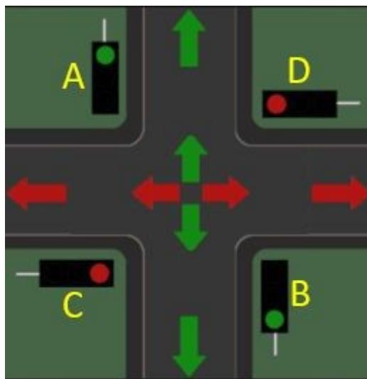
Ampel A = B und C = D. Hier könnte man so eine Verzweigung einbauen. Das wird man aber direkt bei den Ampeln machen und diese mit einem 4-poligen Kabel an einen Verteiler anschließen.
