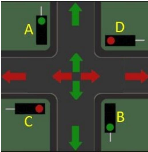
Ampel A = B und C = D. Hier könnte man so eine Verzweigung einbauen. Das wird man aber direkt bei den Ampeln machen und diese mit einem 4-poligen Kabel an einen Verteiler anschließen.
