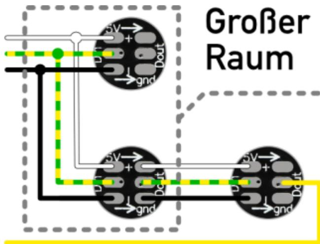
Das folgende Bild zeigt fünf große Räume. Im Programm Generator werden nur die fünf LEDs der oberen Reihe definiert. Alle LEDs ab der zweiten Reihe abwärts sind für den Arduino unsichtbar. Das ist ein zusätzlicher Vorteil ggü. dem CopyLED-Befehl, denn im gezeigten Beispiel unten belegen 12 der 17 LEDs keinen Speicherplatz auf dem Arduino.
