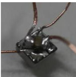
Im Gegensatz zum WS2812-Modul ist bei den folgenden Typen kein Kondensator angelötet.
