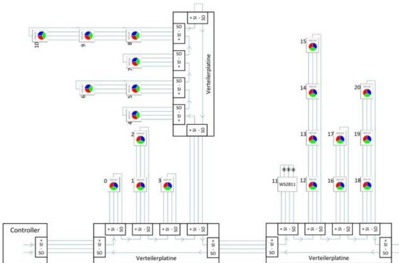
Neben den LEDs sind kleine Nummern welche die „Adresse“ der LED beschreibt. Praktischerweise gibt es die „Intelligenz“ der RGB-LEDs auch als einzelnes IC ohne LED bzw. als kleine Platine mit montiertem IC. Das wird im Rahmen der MobaLedLib genutzt um andere Dinge anzusteuern: Servos, Motoren, Relais, Soundmodule. Diese WS2811-Schaltkreise verhalten sich wie LEDs und haben Anschlüsse an denen man dann einzelne LEDs - oder eben andere Verbraucher - anschließen kann.
