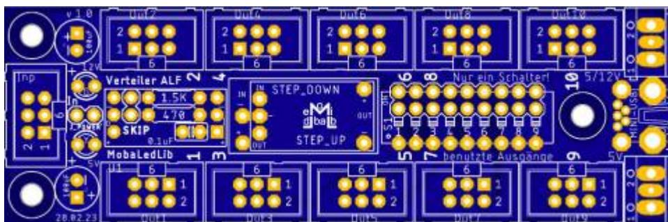
Der Universal Verteiler ALF ist eine Weiterentwicklung des RGB LED Verteilers Universal (200). Der 9-fach DIP-Schalter ersetzt die inneren Jumper seines Vorgängers, was das Überbrücken aufeinanderfolgender ungenutzter Ausgänge ermöglicht. Als Besonderheit verfügt er als einziger über die Option eines 12V-StepUp Wandlers. So können beispielsweise LED Reihenschaltungen direkt mit einem 5V-Netzteil betrieben werden.
