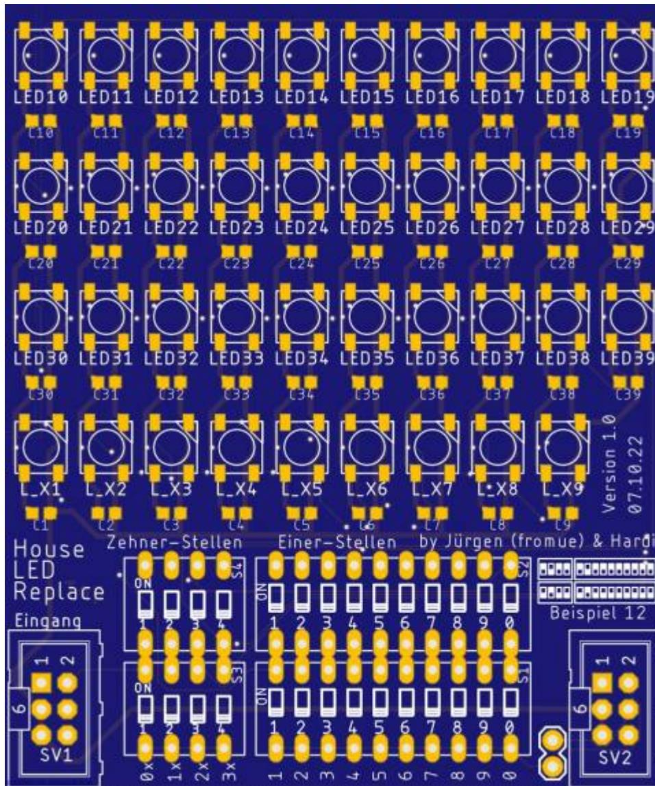
Die Haus-Ersatzplatine ersetzt im Wartungsfall die LEDs/ RGBs/ Servos im Reparaturfall eines auf der Anlage eingebauten Hauses.
