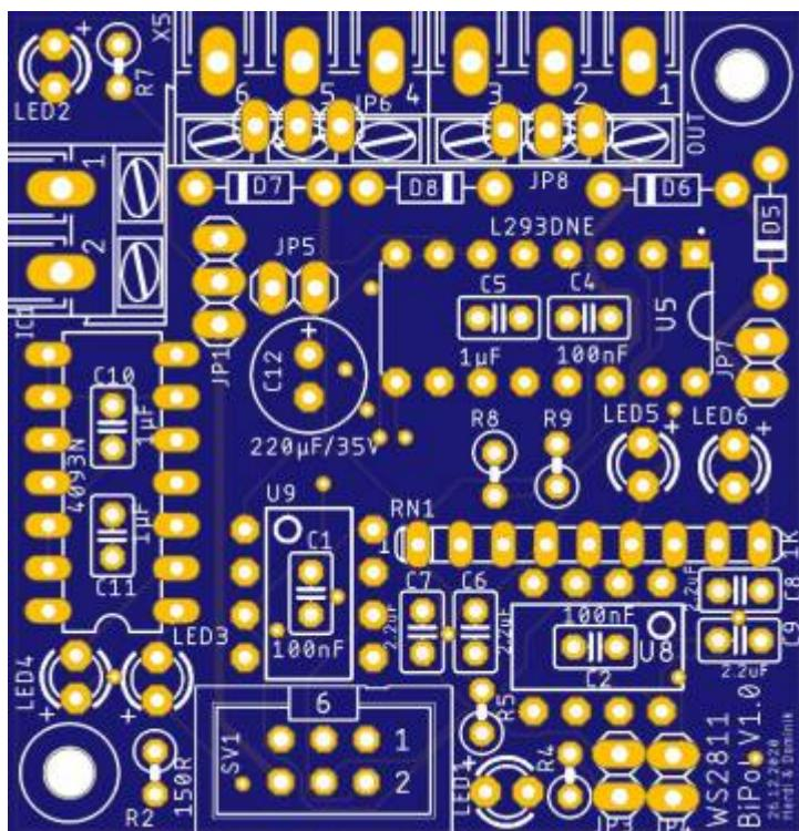
Mit dieser Platine ist es möglich Motoren in beide Richtungen anzusteuern, die Märklin Start-Signale und auch Gleichstrom-Weichen zu schalten.
