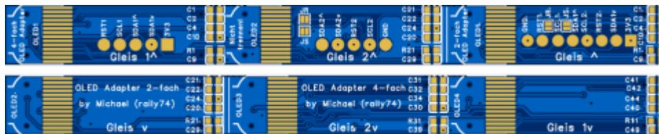
Mit dieser Platine wird es möglich sein, 0,87 „-IIC-Displays für eine beidseitige und zweigleisige Bahnsteig-Anzeige zu nutzen.
