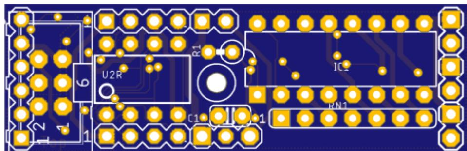
Die Extender Platine kann zur Ansteuerung von Bauteilen verwendet werden, die eine höhere Spannung benötigen, bzw. mehr Strom verbrauchen. Es stehen 3 Ausgänge zur Verfügung. Am 1. Ausgang stehen 400mA zur Verfügung, an den anderen Ausgängen 200mA.
