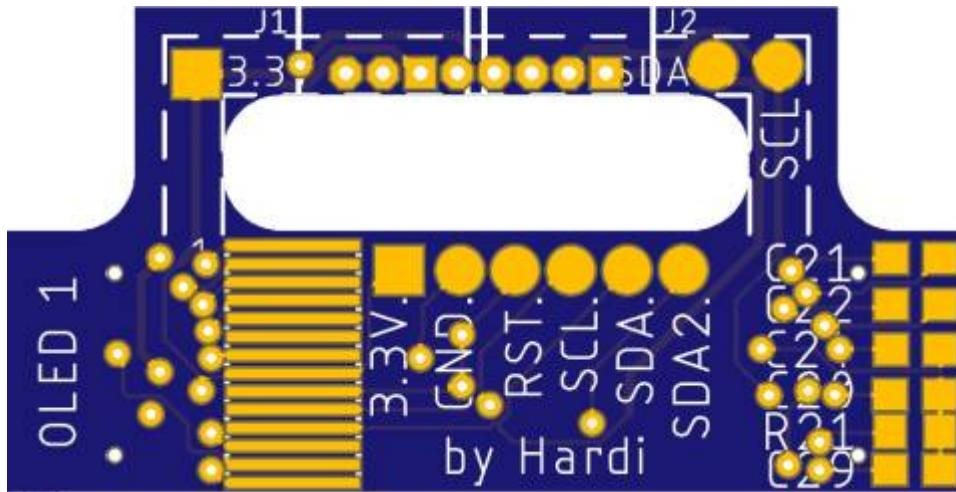
Mit dieser Platine ist es möglich die Dicke der Bahnsteig anzeige von vorher 8.40mm auf 3.00mm zu reduzieren bei zwei Displays.
