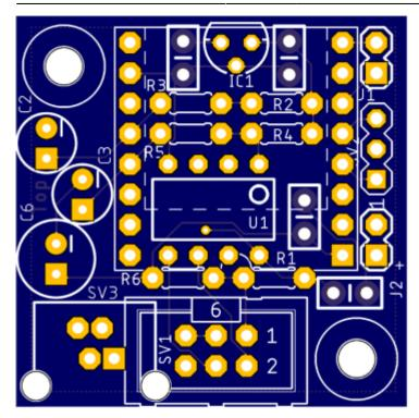
Das Soundmodul wird zum Abspielen verschiedener Sounds auf der Modellbahn verwendet. Die Platine wird mit einem MP3-TF-16P Soundmodul bestückt. Es können bis zu 14 Sounds direkt abgerufen werden.
