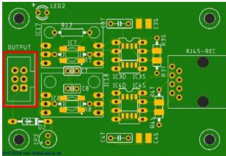
Zur Verlängerung des WS2812 Signals in beiden Richtungen.
