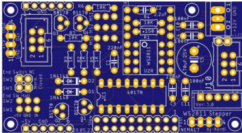
Mit dieser Platine ist es möglich über den LED-Bus einen Steppermotor anzusteuern.
