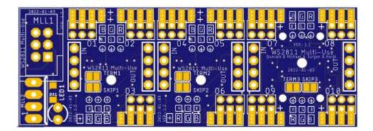
Die Multi-Use Platine ist eine Alternative zu den WS2811 Schokoladentafel-Chips und kann überall eingesetzt werden, wo man mit dem Lötkolben noch dran kommt.
