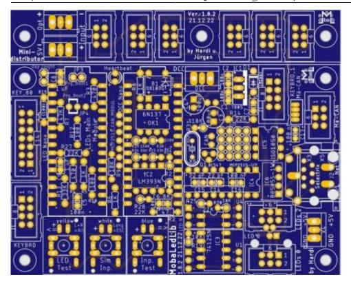
Die Hauptplatine ist eine der beiden Haupt-Zentralen für die MobaLedLib. Diese steuert die LEDs an und sorgt auch für die DCC, CAN, Selectrix und Lnet Kommunikation.
