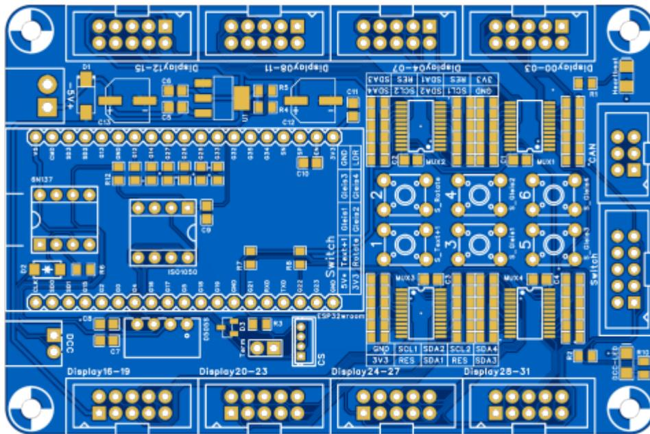
Mit dieser Platine ist es möglich, bis zu 32 OLED Displays auf 750er und 760er Platinen anzusteuern.
