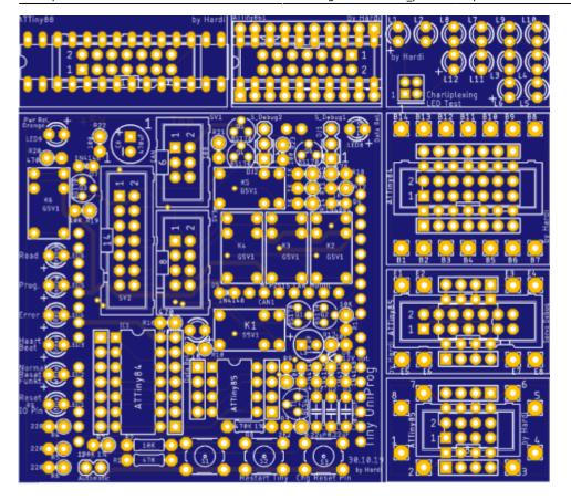
Der Attiny Programmer ist ein elementares Werkzeug, das zum Programmieren der Steuer-ICs "ATtiny" auf der Servoplatine benötigt wird.
