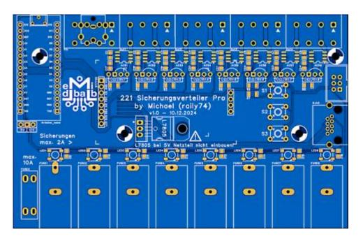
Der Sicherungsverteiler Pro vereint viele Funktionen in sich. Er ist nicht nur Verteiler sondern gleichzeitig auch Messgerät.
