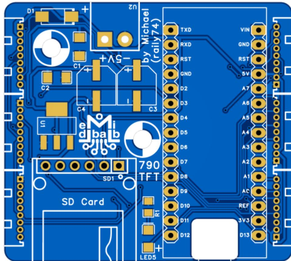
Mit dieser Platine ist es möglich, wahlweise ein 0,96 oder ein 1,8" SPI-TFT-Display (ST7735) als Werbebildschirm einzusetzen.
