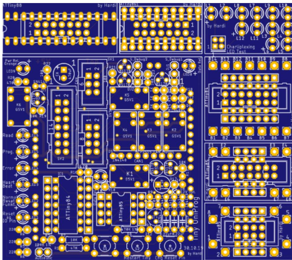
Der Attiny Programmer ist ein elementares Werkzeug, das zum Programmieren der Steuer-ICs „ATTiny“ auf der Servoplatine benötigt wird.
