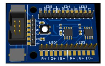
Bei der Beleuchtung eines Objektes ist es oft notwendig, Einzel-LEDs, z.B. für Funktionsbeleuchtung, mit mehreren Strängen RGB-LEDs zu kombinieren. Diese Platine entstand nun mit der Motivation den "Kabelsalat"
