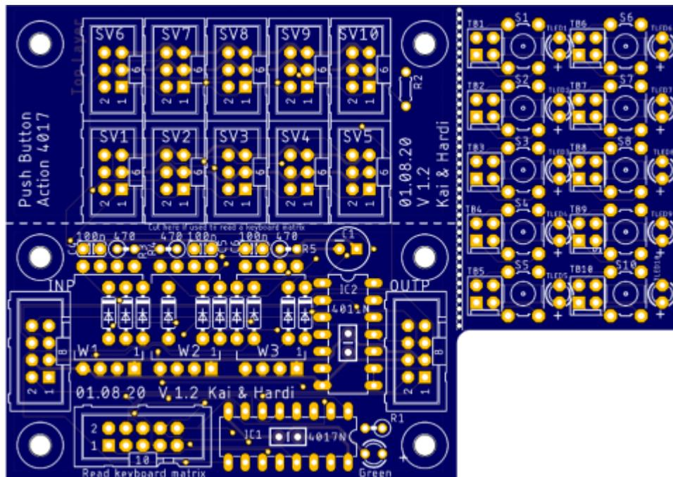
Die Pushbutton Platine kann zum Einlesen von mehreren Tastern und Schaltern verwendet werden. Es können mehrere Platinen miteinander verbunden werden.
