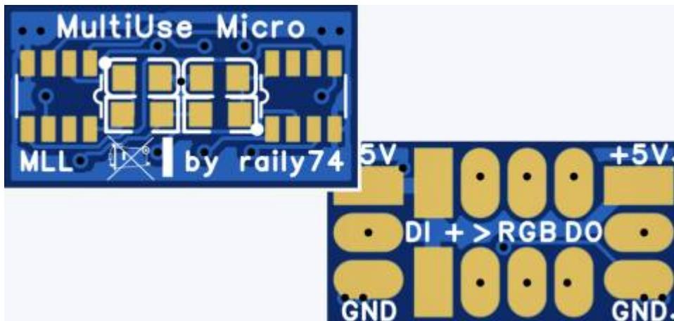
Die Multi-Use Micro Platine ist die MLL-kompatible Alternative zu den WS2811 Schokoladentafel-Chips. Sie bietet bei kleinerer Bauform den Anschluss von sechs statt drei LEDs und ist universell einsetzbar. Die Verkabelung ist zu 100% auf die der WS2812b-LEDs abgestimmt.
