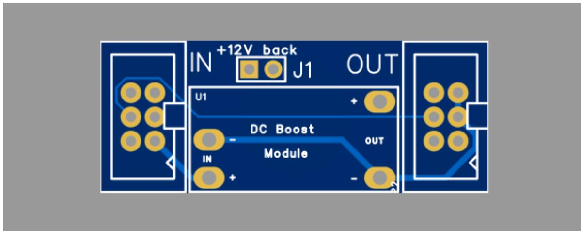
Diese kleine Platine kann aus der 5V Versorgungsspannung 12V generieren. Gedacht ist sie, wenn man keine separate 12V Spannungsebene am Verteiler hat, für ein kleines Projekt dennoch 12V braucht.
