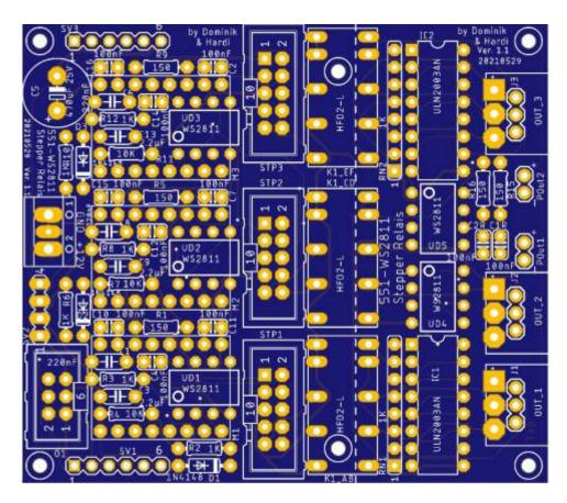
Mit dieser Platine ist es möglich über den LED-Bus bis zu drei Stepper und drei Relais zur Herzstückpolarisierung anzusteuern.
