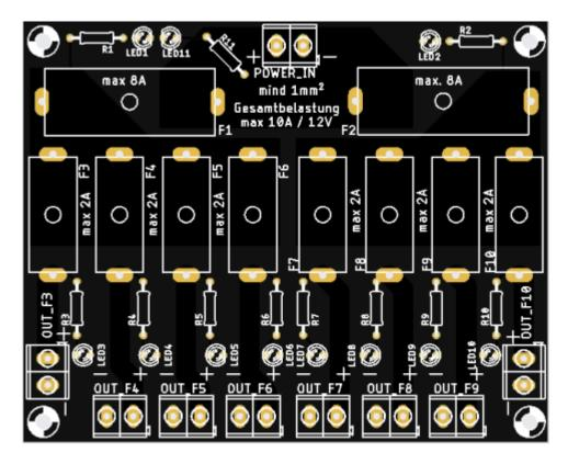
Der Sicherungsverteiler verzichtet auf jeglichen Schnickschnack der Pro Variante. Ausgefallen Sicherungen signalisiert er mithilfe von zehn Kontroll-LEDs. Mit dem Sicherungsverteiler können ebenso bis zu acht getrennt abgesicherte Stromkreise zur Verfügung gestellt werden.
