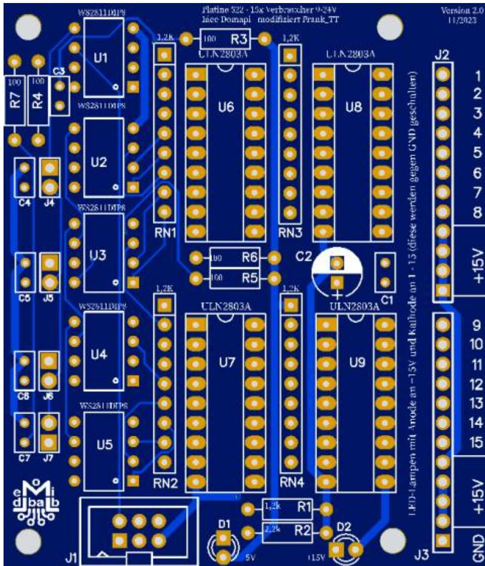
An diese Platine können bis zu 15 Verbraucher angeschlossen werden.
