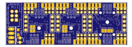
Die Multi-Use Platine ist eine Alternative zu den WS2811 Schokoladentafel-Chips und kann überall eingesetzt werden, wo man mit dem Lötkolben noch dran kommt.
