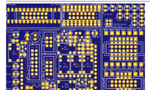
Der Attiny Programmer ist ein elementares Werkzeug, das zum Programmieren der Steuer-ICs "ATtiny" auf der Servoplatine benötigt wird.
