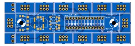
**Neu!** Der Universal Verteiler Pro ist die Weiterentwicklung beider Vorgängerversionen. Mit seinem 12-fach DIP Switch macht er das Überbrücken ungenutzter Ausgänge sehr komfortabel. Zudem besitzt er je eine RGB-LED ankommend und rückfließend, um die Datensignale auch nach langen Kabelstrecken aufzubereiten.
