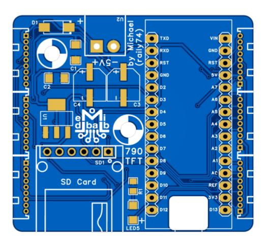
Mit dieser Platine ist es möglich, wahlweise ein 0,96 oder ein 1,8" SPI-TFT-Display (ST7735) als
