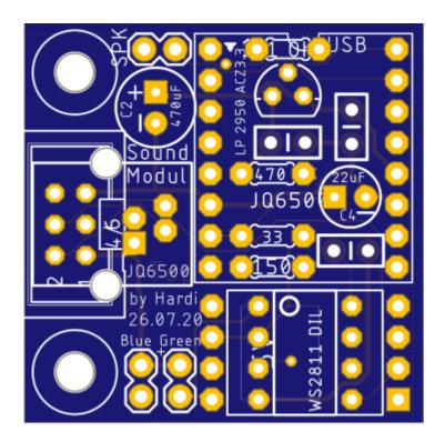
Das Soundmodul wird zum Abspielen verschiedener Sounds auf der Modellbahn verwendet. Die Platine wird mit einem JQ6500 Soundmodul bestückt. Es können bis zu 5 Sounds direkt abgerufen werden.
