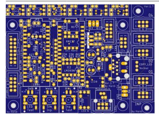
Die Hauptplatine ist eine der beiden Haupt-Zentralen für die MobaLedLib. Diese steuert die Leds an und sorgt auch für die DCC, CAN, Selectrix und Lnet Kommunikation.
