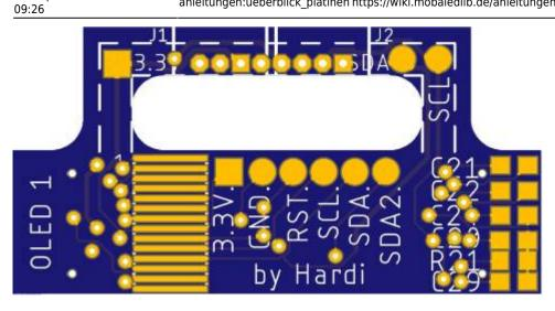
Mit dieser Platine ist es möglich die Dicke der Bahnsteiganzeige von vorher 8.40mm auf 3.00mm zu reduzieren bei zwei Displays.
