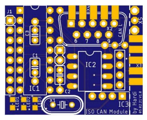
Dieses CAN Modul stellt einen galvanisch isoliertem CAN Bus bereit und hat dabei die Abmessungen und die Pinbelegung eines günstigen DIY-MCP2515 CAN Modul. Dadurch kann es einfach ausgetauscht werden.
