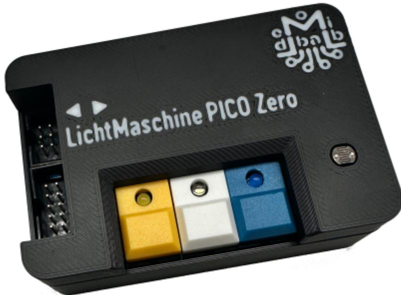
Bei der LichtMaschine PICO Zero verschmelzen Baugruppen zu einem fertigen Gerät, ohne dass man löten, schrauben oder kleben muss.
