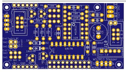
Mit dieser Platine ist es möglich über den LED-Bus einen Steppermotor anzusteuern.
