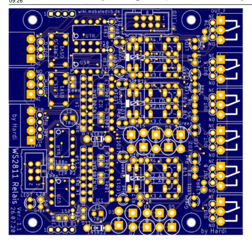
Auf der Relais Platine befinden sich mehrere Relais. So können auch höhere Spannungen mit der MobaLedLib geschaltet werden.
