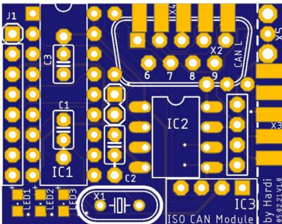
Dieses CAN Modul stellt einen galvanisch isoliertem CAN Bus bereit und hat dabei die Abmessungen und die Pinbelegung eines günstigen DIY-MCP2515 CAN Modul. Dadurch kann es einfach ausgetauscht werden.
