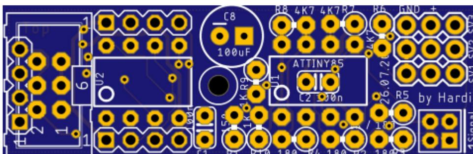
Mit dem Servomodul können bis zu drei Servos separat angesteuert werden. Alternativ kann die Platine auch für Charlieplexing verwendet werden.
