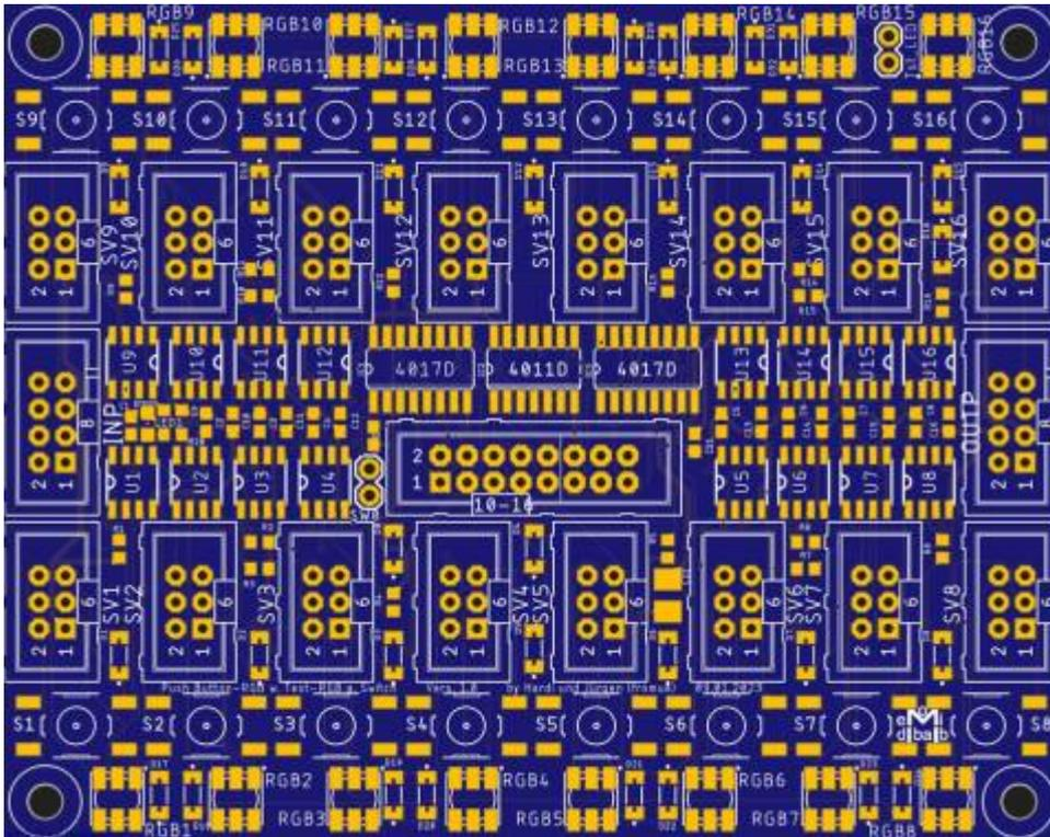
Diese Platine ist eine Überarbeitung bzw. Erweiterung der seitherigen Push-Button Action-Platine 4017. Sie ist für 16 Taster mit LED- oder RGB-Beleuchtung entwickelt worden.
