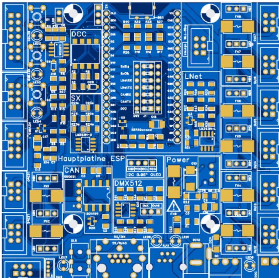
Die LichtMaschine Pro ist eine der beiden Haupt-Zentralen für die MobaLedLib. Diese steuert die Leds an und sorgt auch für die DCC, CAN, Selectrix und Lnet Kommunikation. Die LichtMaschine Pro ist eine Weiterentwicklung der Hauptplatine. Sie vereint die Hauptplatine und den ESP-Adapter in einer einzigen Platine. Zudem ist sie SMD-vorbestückt und erleichtert den Zusammenbau. Weitere Funktionen sind native DMX-Unterstützung, eigene Spannungsversorgung, zwei Heartbeats je Kanal uvm.
