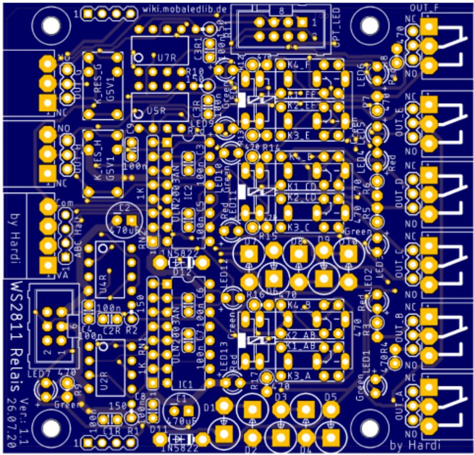
Auf der Relais Platine befinden sich mehrere Relais. So können auch höhere Spannungen mit der MobaLedLib geschaltet werden. Zusätzlich kann die Platine auch für die Herzstückpolarisation oder für das ABC Bremsen verwendet werden.
