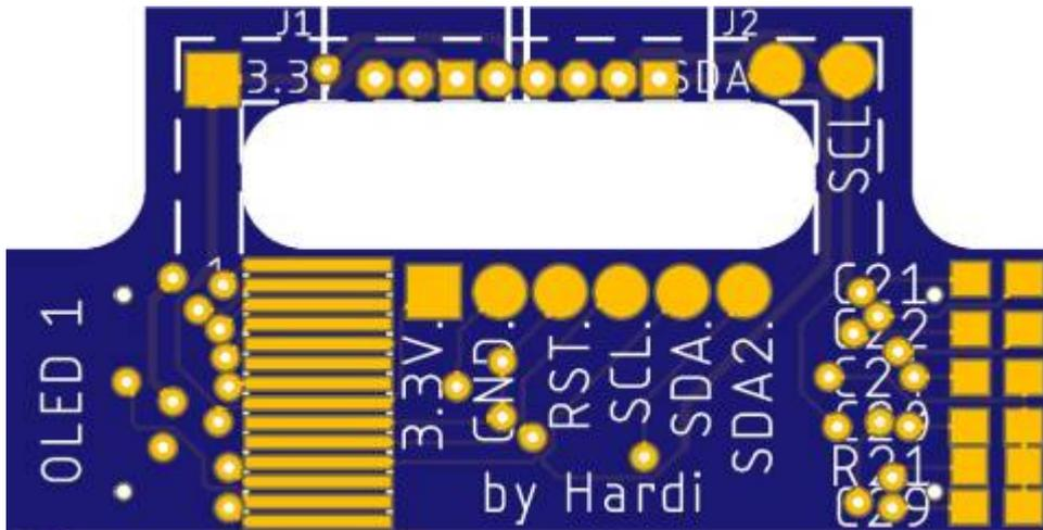
Mit dieser Platine ist es möglich die Dicke der Bahnsteiganzeige von vorher 8.40mm auf 3.00mm zu reduzieren bei zwei Displays.
