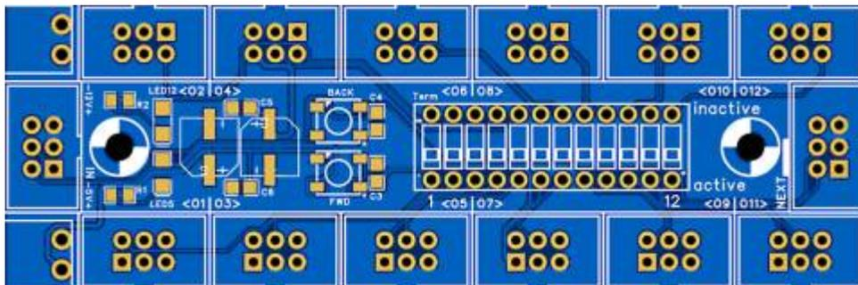
**Neu!** Der Universal Verteiler Pro ist die Weiterentwicklung beider Vorgängerversionen. Mit seinem 12-fach DIP Switch macht er das Überbrücken ungenutzter Ausgänge sehr komfortabel. Zudem besitzt er je eine RGB-LED ankommend und rückfließend, um die Datensignale auch nach langen Kabelstrecken aufzubereiten. Durch die Nutzung von SMD Bauteilen bietet er 12+1 statt 9+1 Ausgänge auf gleicher Fläche.
