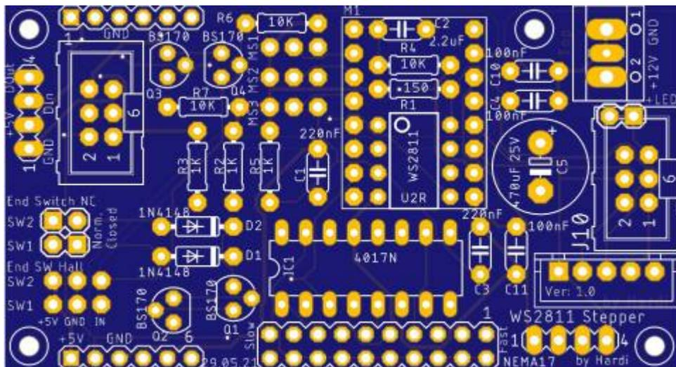
Mit dieser Platine ist es möglich über den LED-Bus einen Stepermotor anzusteuern.
