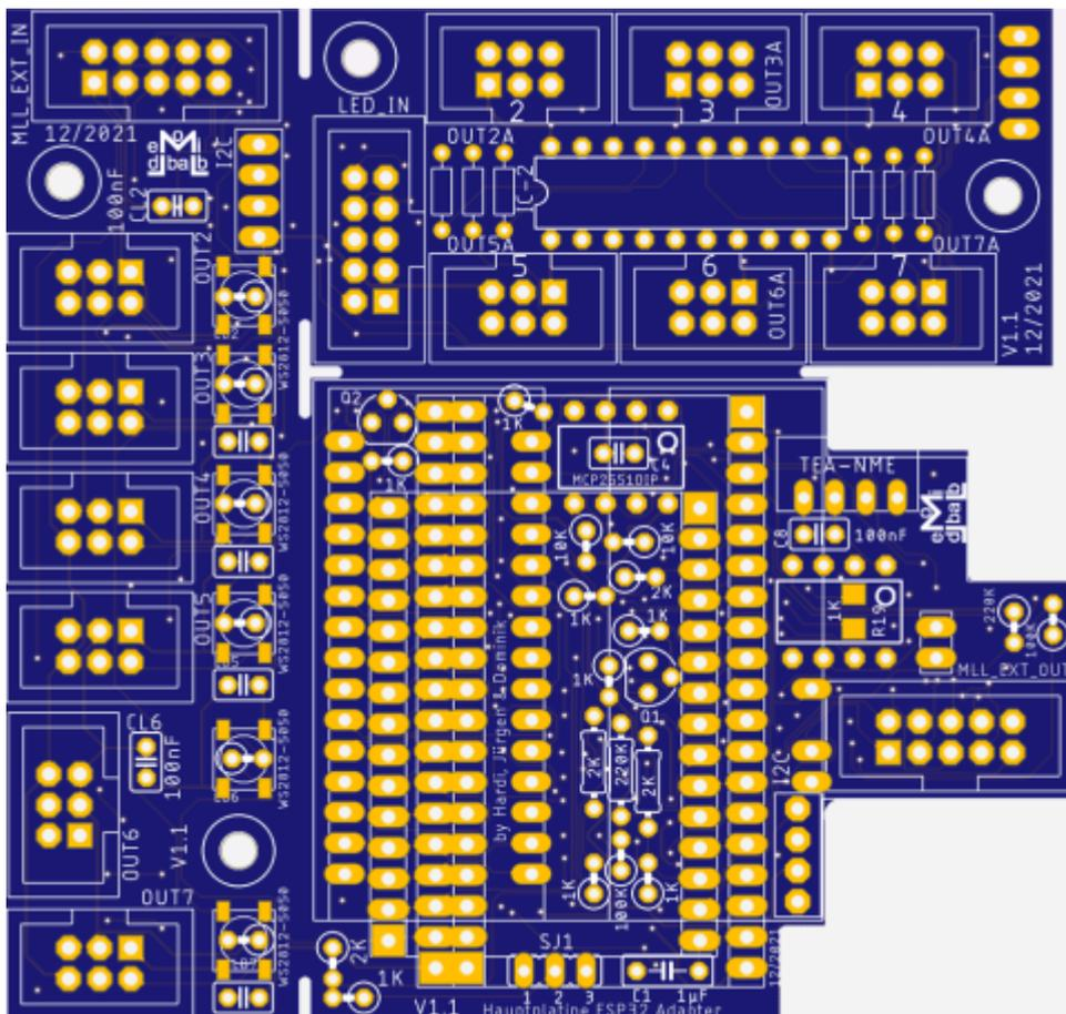
Mit dieser Adapter-Platine ist es möglich, auf der Hauptplatine einen ESP32 als LED-Arduino zu verwenden.
