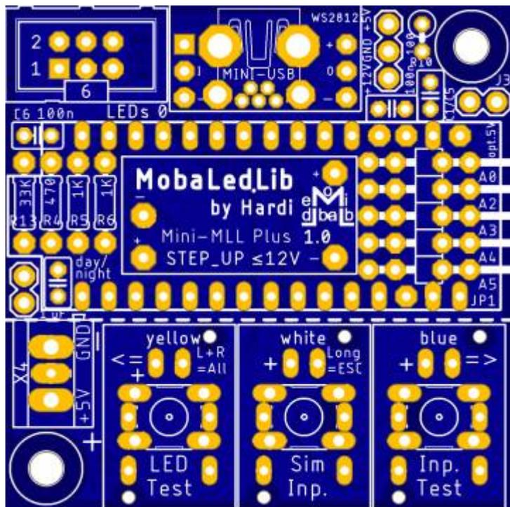
Die Mini MLL Plus ist eine kleine Ausführung der Hauptplatine. Sie besitzt keine DCC/Can/Selectrix/LNet Kommunikation und eignet sich sehr gut für Dioramen oder als Testplatine.
