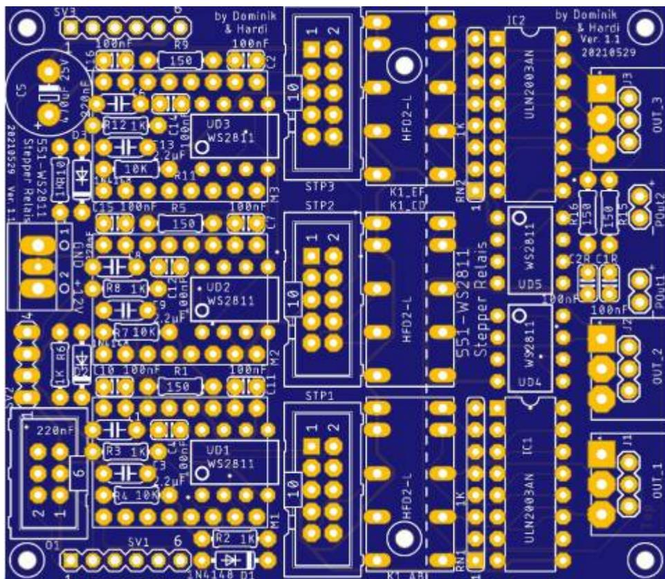
Mit dieser Platine ist es möglich über den LED-Bus bis zu drei Stepper und drei Relais zur Herzstückpolarisierung anzusteuern. Zudem stehen zwei Power-LED-Kanäle mit je 200mA zur Verfügung.
