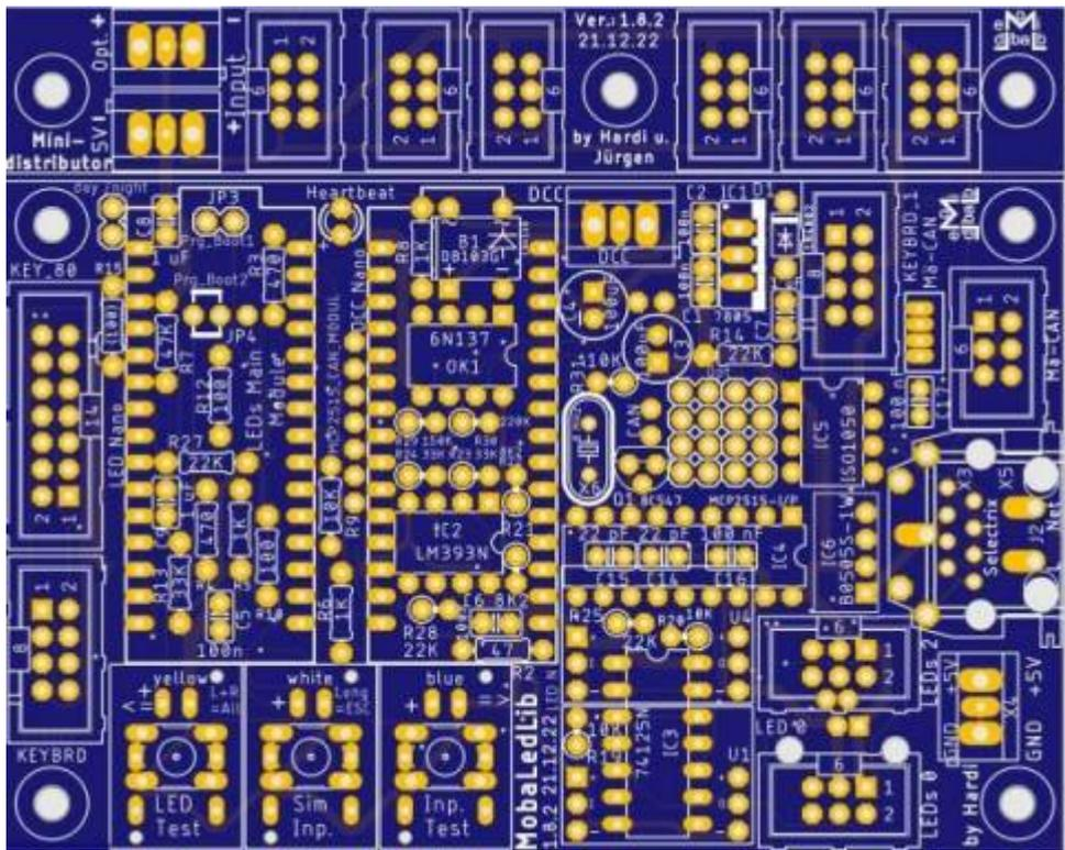
Die Hauptplatine ist eine der beiden Haupt-Zentralen für die MobaLedLib. Diese steuert die LEDs an und sorgt auch für die DCC, CAN, Selectrix und Lnet Kommunikation.
