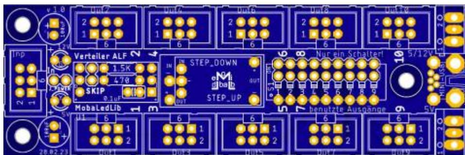
Der Universal Verteiler ALF ist eine Weiterentwicklung des RGB LED Verteilers Universal (200). Der 9-fach DIP-Schalter ersetzt die inneren Jumper seines Vorgängers, was das Überbrücken aufeinanderfolgender ungenutzter Ausgänge ermöglicht.
