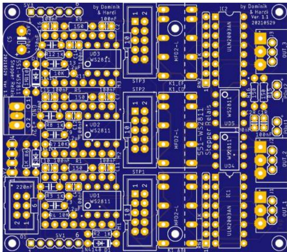
Mit dieser Platine ist es möglich über den LED-Bus bis zu drei Stepper und drei Relais zur Herzstückpolarisierung anzusteuern.
