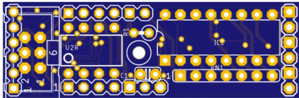
Die Extender Platine kann zur Ansteuerung von Bauteilen verwendet werden, die eine höhere Spannung benötigen, bzw. mehr Strom verbrauchen.
