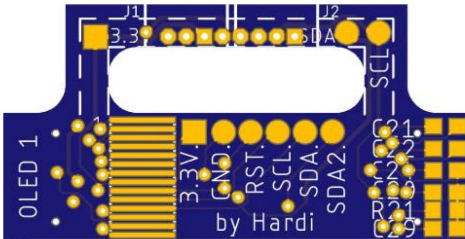
Mit dieser Platine ist es möglich die Dicke der Bahnsteigeanzeige von vorher 8.40mm auf 3.00mm zu reduzieren bei zwei Displays.
