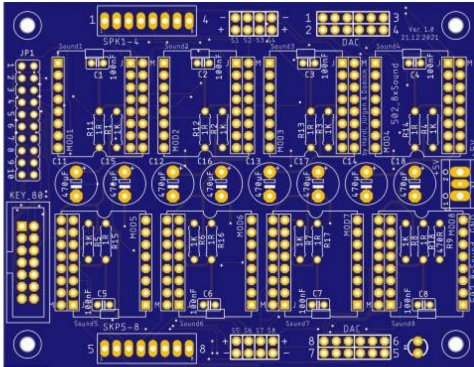
Soundmodul für bis zu 8 Soundmodule, welche direkt über die Hauptplatine angesteuert werden können.
