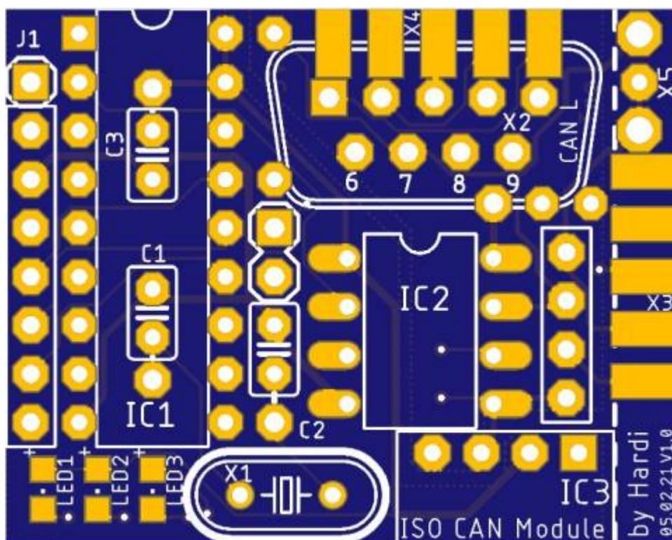
Dieses CAN Modul stellt einen galvanisch isoliertem CAN Bus bereit und hat dabei die Abmessungen und die Pinbelegung eines günstigen DIY-MCP2515 CAN Modul.
