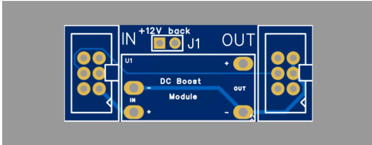
Diese kleine Platine kann aus der 5V Versorgungsspannung 12V generieren.
