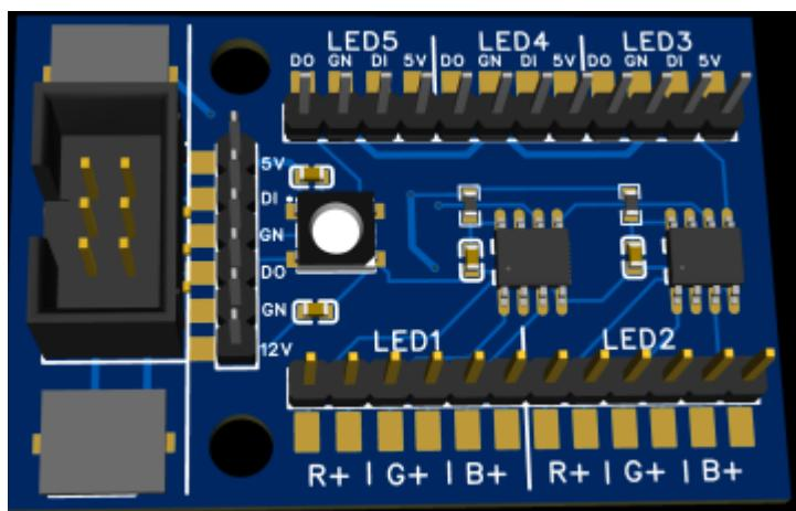
Bei der Beleuchtung eines Objektes ist es oft notwendig, Einzel-LEDs, z.B. für Funktionsbeleuchtung, mit mehreren Strängen RGB-LEDs zu kombinieren. Diese Platine entstand nun mit der Motivation den „Kabelsalat“ rund um die Knotenpunkte etwas aufzuräumen und so den Einbau zu vereinfachen aber auch die Funktionssicherheit zu erhöhen.
