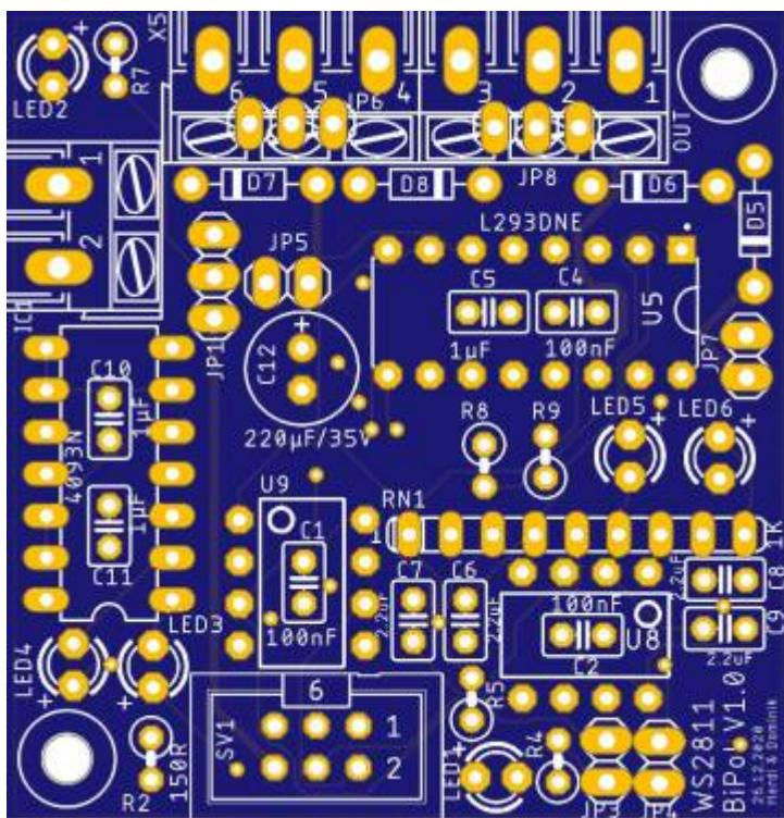
Mit dieser Platine ist es möglich Motoren in beide Richtungen anzusteuern, die Märklin Start-Signale
