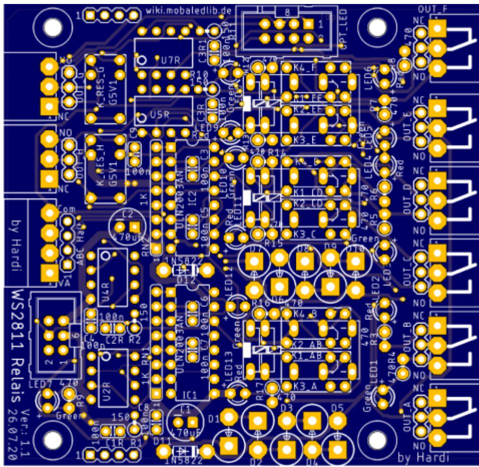
Auf der Relais Platine befinden sich mehrere Relais. So können auch höhere Spannungen mit der MobaLedLib geschaltet werden.
