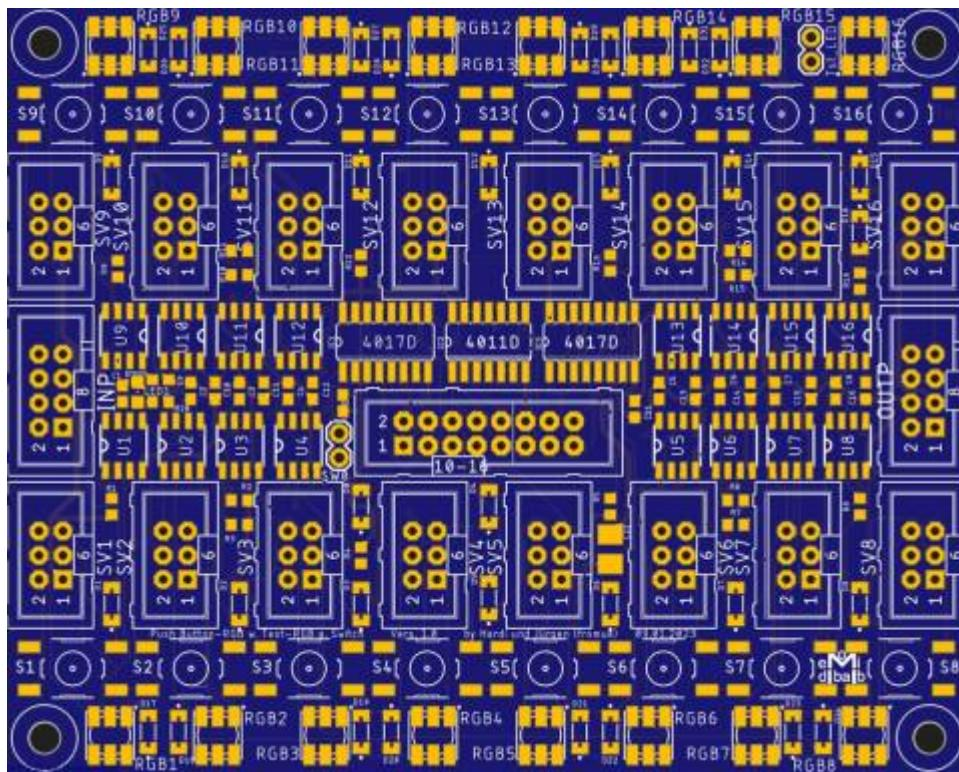
Diese Platine ist eine Überarbeitung bzw. Erweiterung der seitherigen Push-Button Action-Platine 4017. Sie ist für 16 Taster mit LED- oder RGB-Beleuchtung entwickelt worden.
