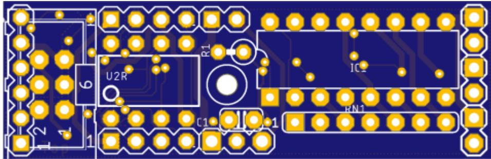
Die Extender Platine kann zur Ansteuerung von Bauteilen verwendet werden, die eine höhere Spannung benötigen, bzw. mehr Strom verbrauchen.
