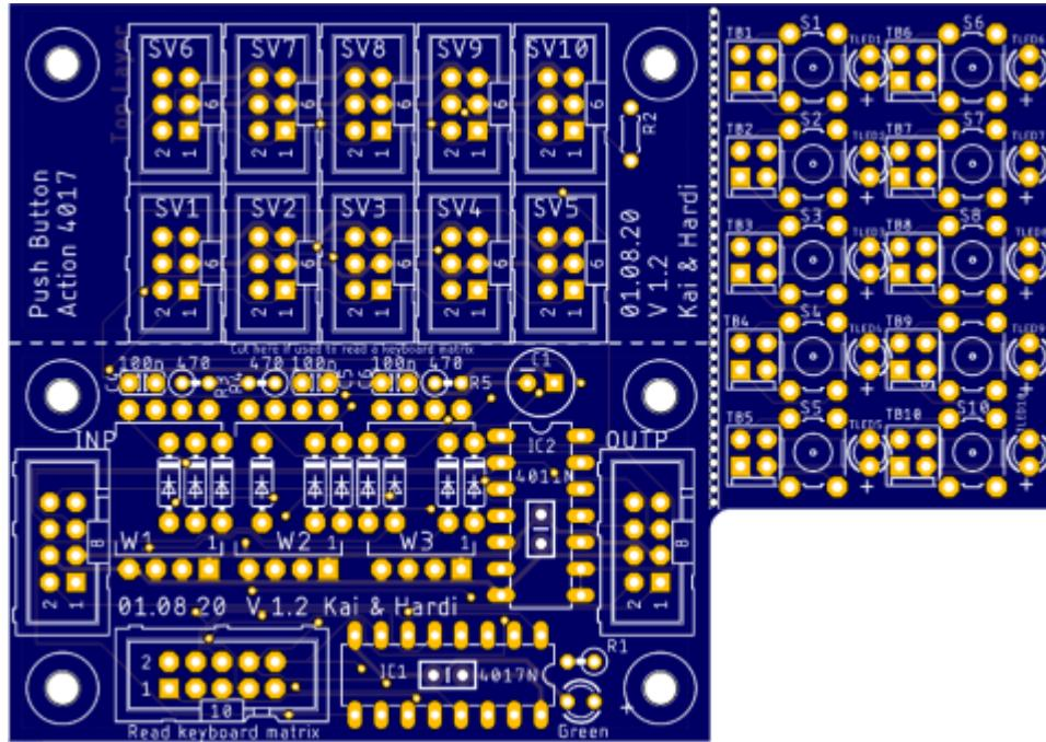
Die Pushbutton Platine kann zum Einlesen von mehreren Tastern und Schaltern verwendet werden. Es können mehrere Platinen miteinander verbunden werden. Dadurch können bis zu 80 Taster mit einem Arduino eingelesen werden. Alternativ kann auch eine Matrix verwendet werden, das ist zum Beispiel in einem Weichenstellpult sinnvoll.
