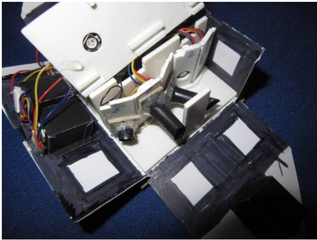
Der Grundanschluss des Hauses an die MLL Verkabelung bzw. Verteilerplatine erfolgt über den 3D – Gehäuseadapter für Pfostenstecker von Jürgen.
