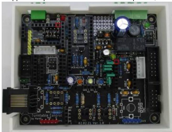
Nun verbindet ihr den Minuspol eures Multimeters mit einem Massepol auf der Platine. Nachfolgend sind alle möglichen Massepunkte markiert, auch wenn diese durch Module verdeckt sein könnten.
