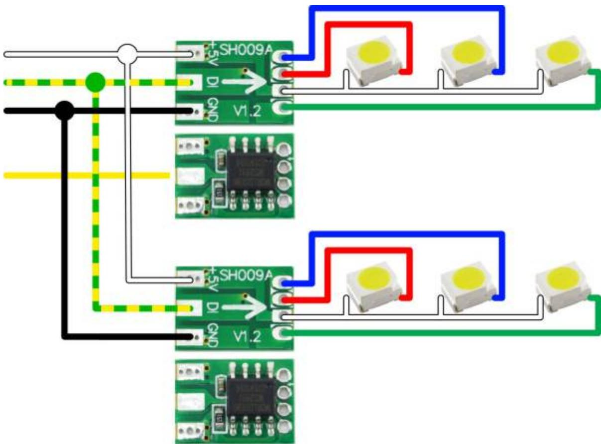
Wenn in einem Raum vier oder mehr Einzel-LEDs gebraucht werden, um den Raum beispielsweise gleichmäßig auszuleuchten, können WS2811-Chips ganz einfach parallel angeschlossen werden. Um all diese Einzel-LEDs innerhalb eines belebten Hauses gleichzeitig ein- und auszuschalten, muss der WS2811 beispielsweise mit der Funktion ROOM\_BRIGHT angesteuert werden. Näheres dazu findet man als Tipp in der Erklärung der [Belebtes Haus-Funktion](#).
