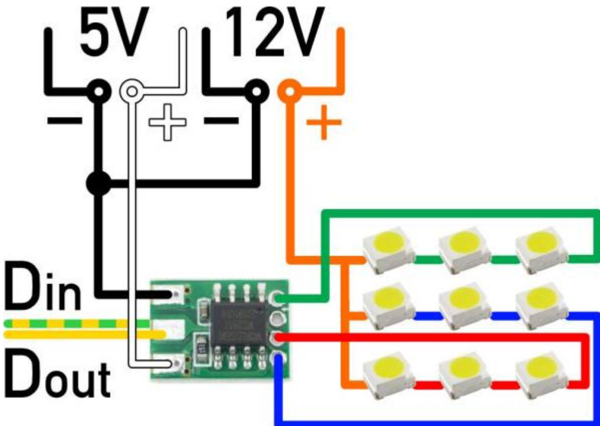
Einzel-LEDs und Reihenschaltungen dürfen **NICHT** im Mischbetrieb an einem WS2811 betrieben werden. Einzel-LEDs müssen immer mit 5 Volt versorgt werden und nur die Reihenschaltungen, die 12 Volt erfordern mit 12 Volt. Erforderlich werden 12 Volt ab zwei blauen/weißen LEDs oder ab drei roten/grünen/gelben LEDs. Bei nur zwei weißen/blauen bzw. drei roten LEDs kann ein zusätzlicher Widerstand innerhalb der Reihe erforderlich sein.
