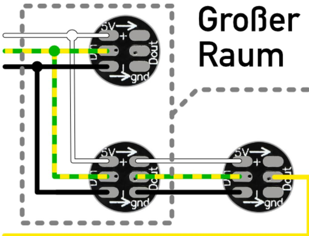
Wenn in einem Raum zwei oder mehr RGB-LEDs gebraucht werden, um den Raum beispielsweise gleichmäßig auszuleuchten, können WS2812B-LEDs ganz einfach parallel angeschlossen werden. Diese parallel angeschlossenen LEDs bekommen alle das gleiche Signal für den Dateneingang und reagieren somit auch synchron.
