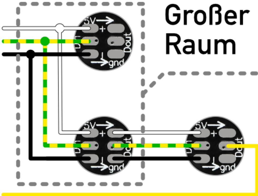
Wenn in einem Raum zwei oder mehr RGB-LEDs gebraucht werden, um den Raum beispielsweise gleichmäßig auszuleuchten, können WS2812B-LEDs ganz einfach parallel angeschlossen werden. Diese parallel angeschlossenen LEDs bekommen alle das gleiche Signal für den Dateneingang und reagieren somit auch synchron.
