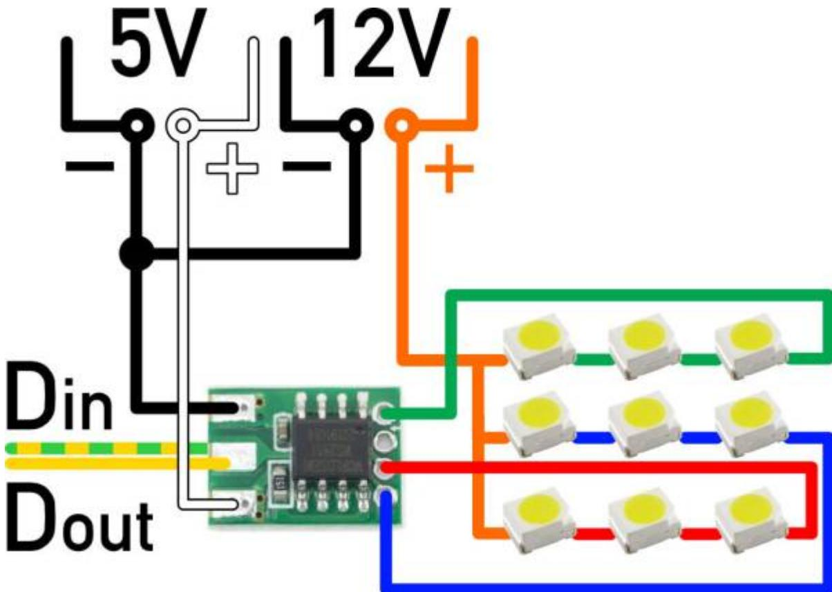
**!** Einzel-LEDs und Reihenschaltungen können wie im oberen Beispiel gezeigt, im Mischbetrieb an einem WS2811 betrieben werden. Dabei sollten Einzel-LEDs aber nach wie vor mit 5 Volt versorgt werden und nur die Reihenschaltungen, die 12 Volt erfordern mit 12 Volt. Erforderlich werden 12 Volt bei mehr als einer blauen/weißen LED oder bei mehr als zwei roten/grünen/gelben LED.
