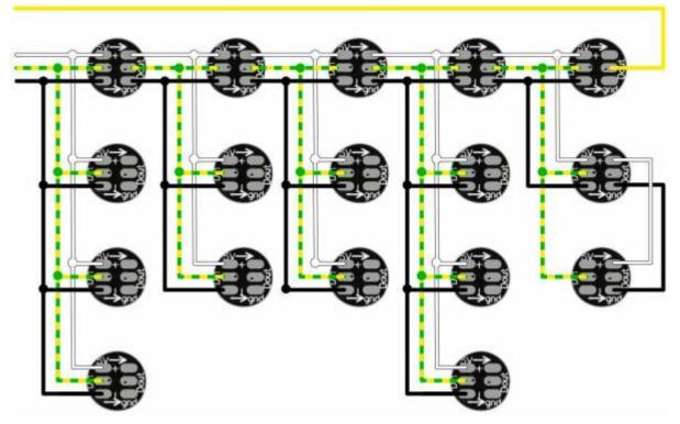
Wenn in einem Raum zwei oder mehr RGB-LEDs gebraucht werden, um den Raum beispielsweise gleichmäßig auszuleuchten, können WS2812B-LEDs ganz einfach parallel angeschlossen werden. Diese parallel angeschlossenen LEDs bekommen alle das gleiche Signal für den Dateneingang und reagieren somit auch synchron.
