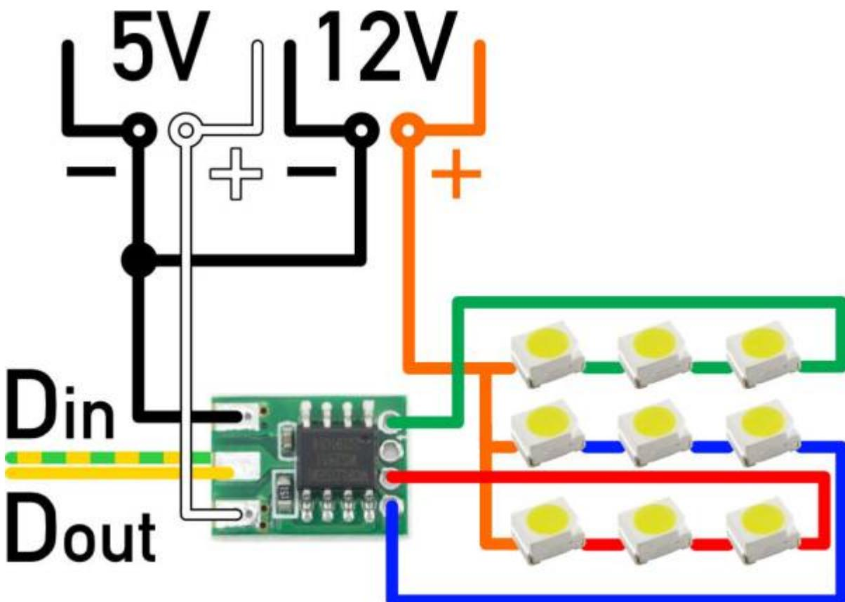
Einzel-LEDs und Reihenschaltungen können wie im oberen Beispiel gezeigt, im Mischbetrieb an einem WS2811 betrieben werden. Dabei sollten Einzel-LEDs aber nach wie vor mit 5 Volt versorgt werden und nur die Reihenschaltungen, die 12 Volt erfordern mit 12 Volt. Erforderlich werden 12 Volt bei mehr als einer blauen/weißen LED oder bei mehr als zwei roten/grünen/gelben LED. Bei nur zwei weißen/blauen bzw. drei roten LEDs ist ein zusätzlicher Widerstand innerhalb der Reihe erforderlich.
