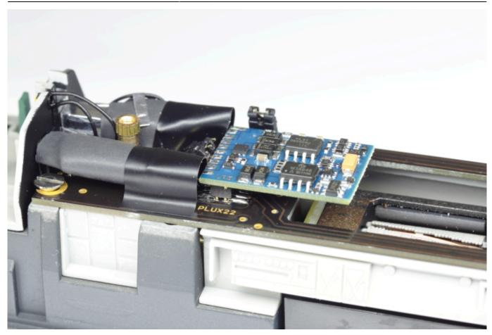
Die PLUX22 Buchse ist von fischer-modell (siehe Übersicht) und wurde nach unten hängend in die Platine eingelötet.
