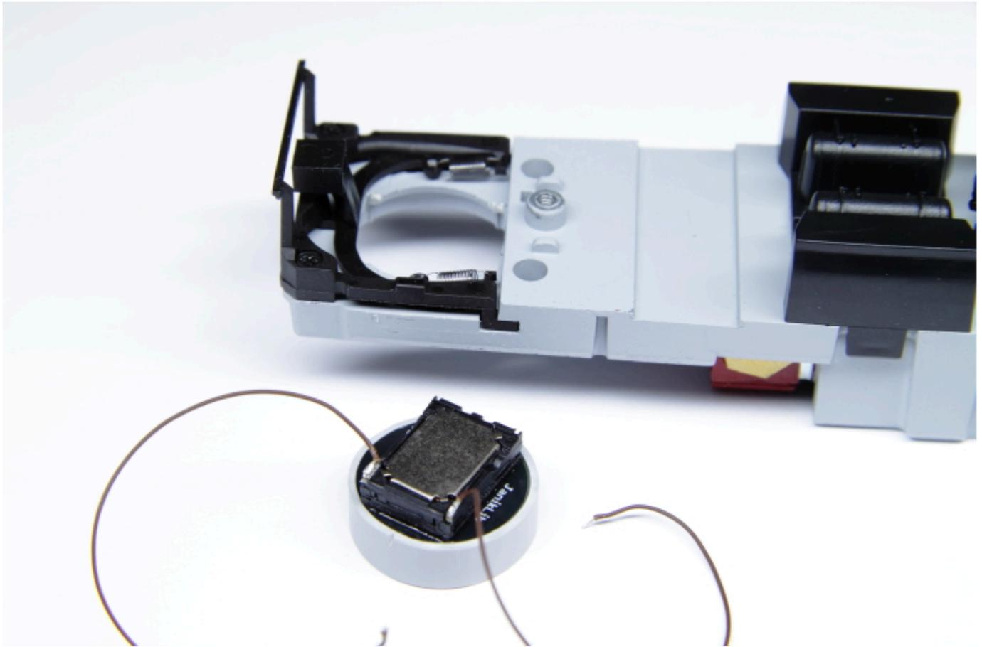
Bei der V80 hat die 20mm Lautsprecheraussparung unten einen Bund mit einem kleineren Durchmesser, damit der Lautsprecher nicht unten raus fällt. Diesen Bund musste ich minimal bearbeiten, damit der Zuckerwürfel unten raus ragen kann. Auf dem folgenden Bild kann man das vielleicht erkennen (es mussten im Rahmen kleine Ecken ausgefeilt werden, damit die Ecken des Zuckerwürfels Platz haben)
