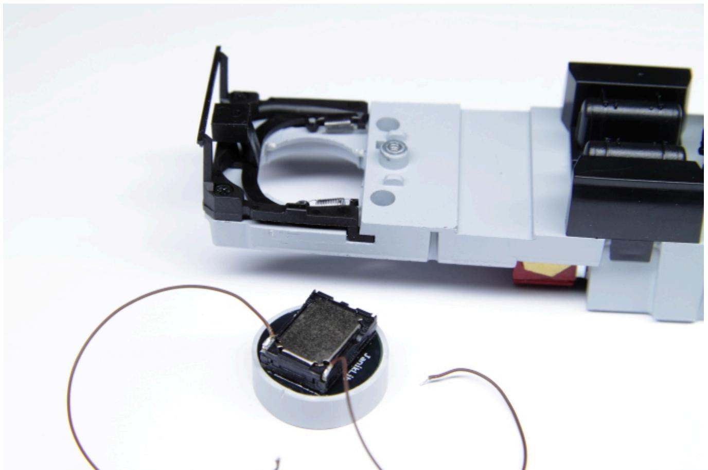
Bei der V80 hat die 20mm Lautsprecheraussparung unten einen Bund mit einem kleineren Durchmesser, damit der Lautsprecher nicht unten raus fällt.
