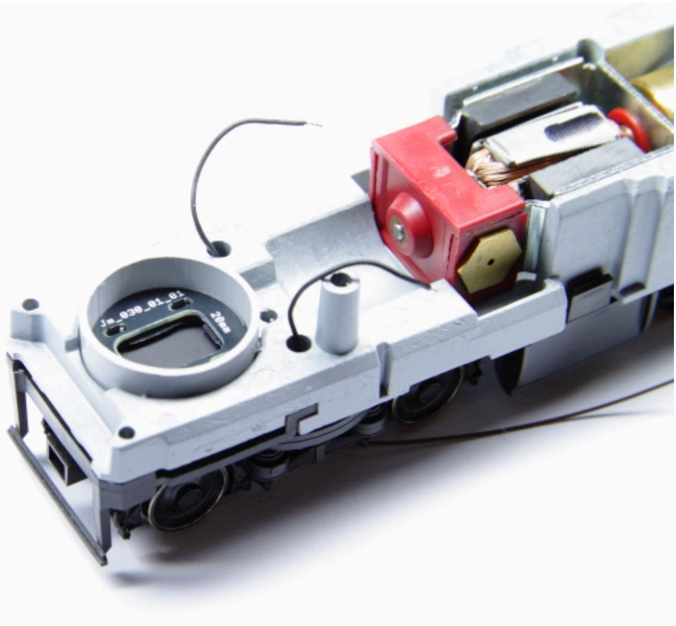
Jede Platine hat auf einer Seite einen Ring ohne Lötstopplack (das schwarze) außen rum, dass der Kleber bestmöglich haften kann.
