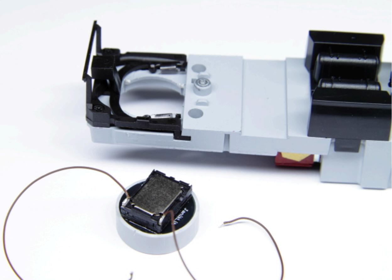
Bei der V80 hat die 20mm Lautsprecheraussparung unten einen Bund mit einem kleineren Durchmesser, damit der Lautsprecher nicht unten raus fällt.
