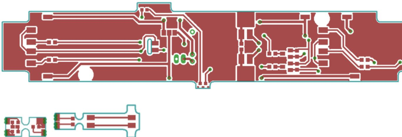
Von Version J2\_029\_01\_03 zu J2\_029\_01\_04 wurden lediglich die Motoranschlüsse auf der Platine gedreht, damit die Lok ohne Änderungen auch direkt vorwärts fährt.
