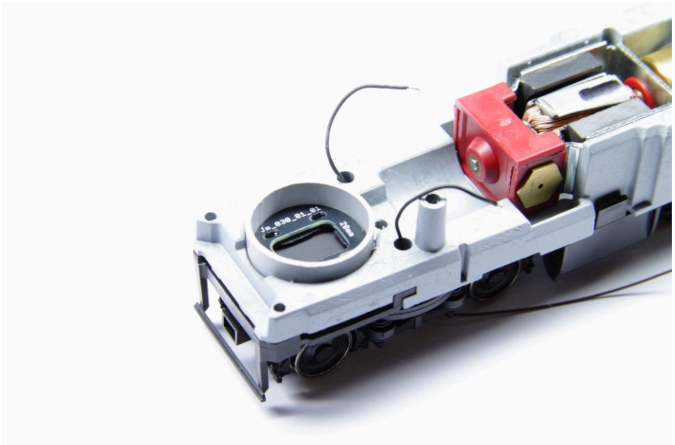
Jede Platine hat auf einer Seite einen Ring ohne Lötstopplack (das schwarze) außen rum, dass der Kleber bestmöglich haften kann.
