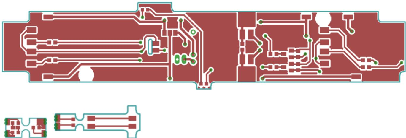
Von Version J2\_029\_01\_03 zu J2\_029\_01\_04 wurden lediglich die Motoranschlüsse auf der Platine gedreht, damit die Lok ohne Änderungen auch direkt vorwärts fährt.
