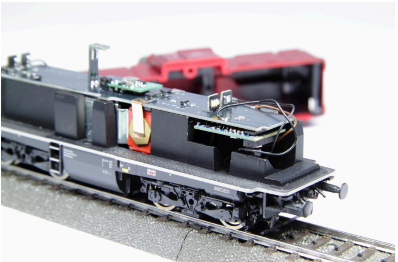
Die SuperCaps passen perfekt in den Decoder-Schacht unter der Lok:
