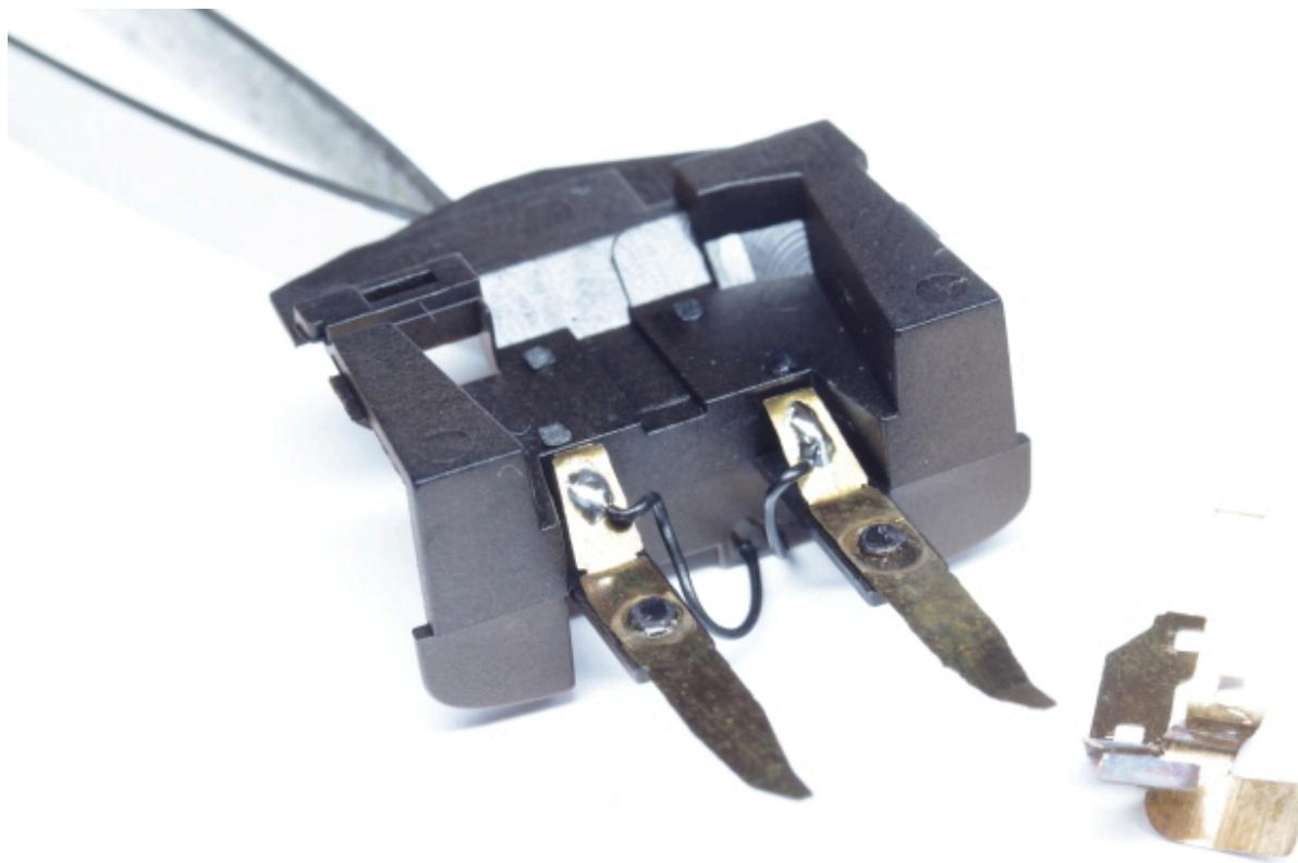
Die Kontaktfahnen müssen nur ausreichend gekürzt werden, damit sie im eingebauten Zustand nicht die Lichtplatine berühren.
