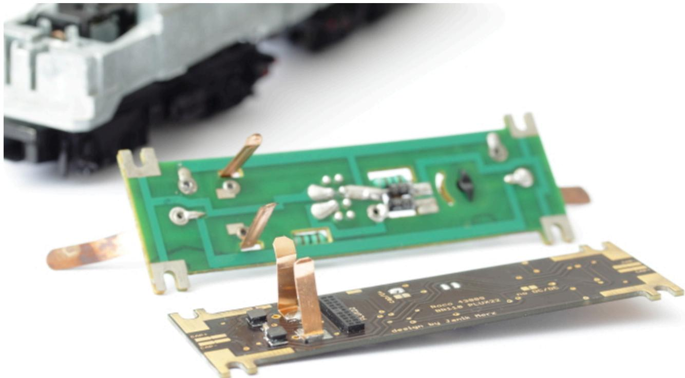
Auf der Platine ist bereits eine Ladeschaltung für einen Pufferkondensator vorhanden.
