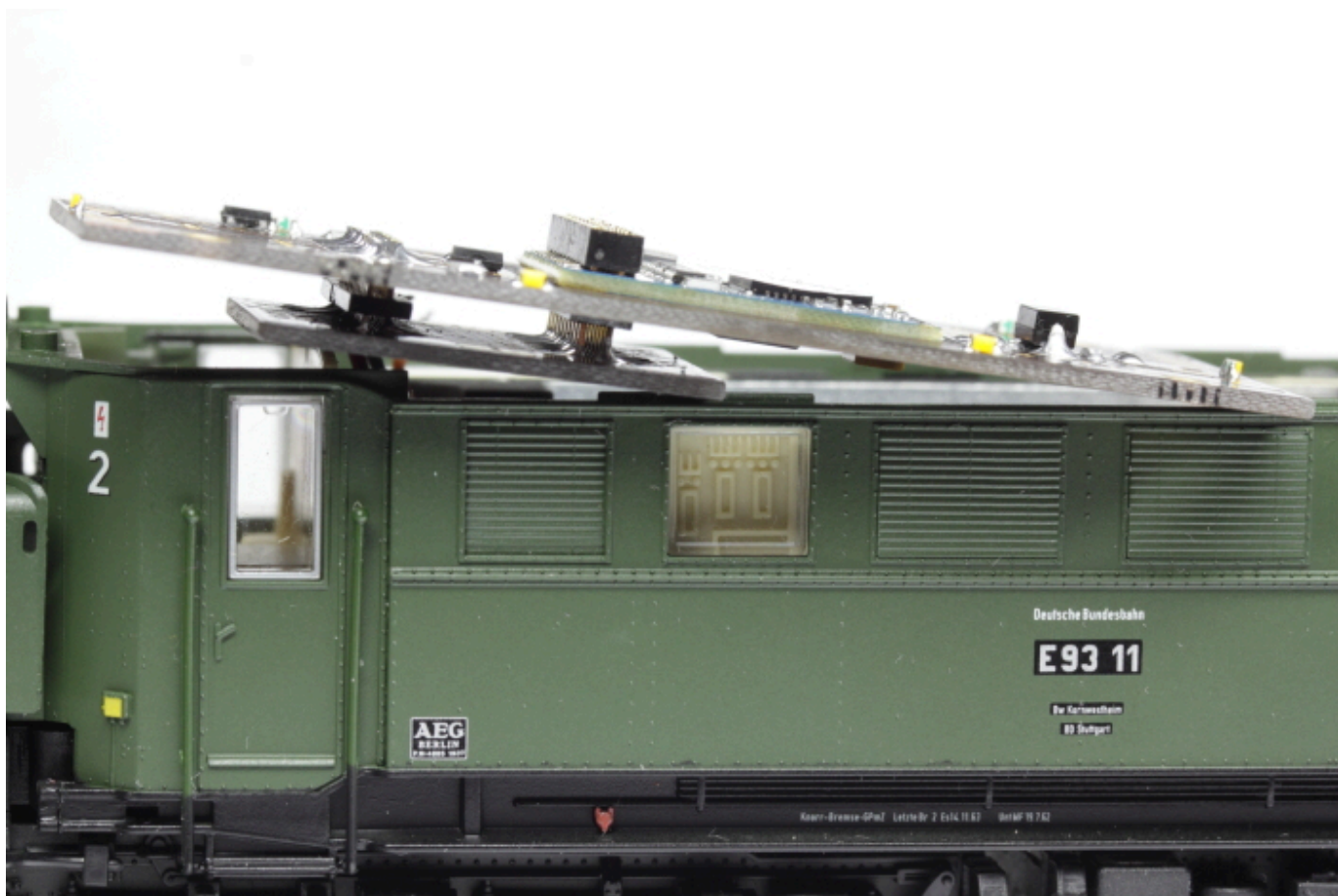
Hier meine Lösung für die Führerstands-Beleuchtung:
