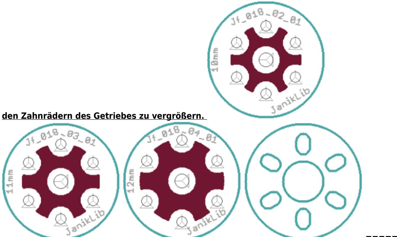
**Plattenherstellung ===== Bei den Bohrschablonen-Platten empfehle ich als Plattenmaterial Aluminium, da die Schablonen dann wahrscheinlich länger halten werden. Bei den Distanzplatten kann man entweder mehrere verschiedene Dicken bestellen, oder wie ich nur 0,5mm und bei Bedarf mehrere verwenden. ===== Kompatible Loks ===== Umbauen kann man alle Loks, in denen die alten Motoren mit Stirnrad Getriebe (Scheibenkollektor klein, groß, Trommelkollektor, HLA) verbaut sind.**
