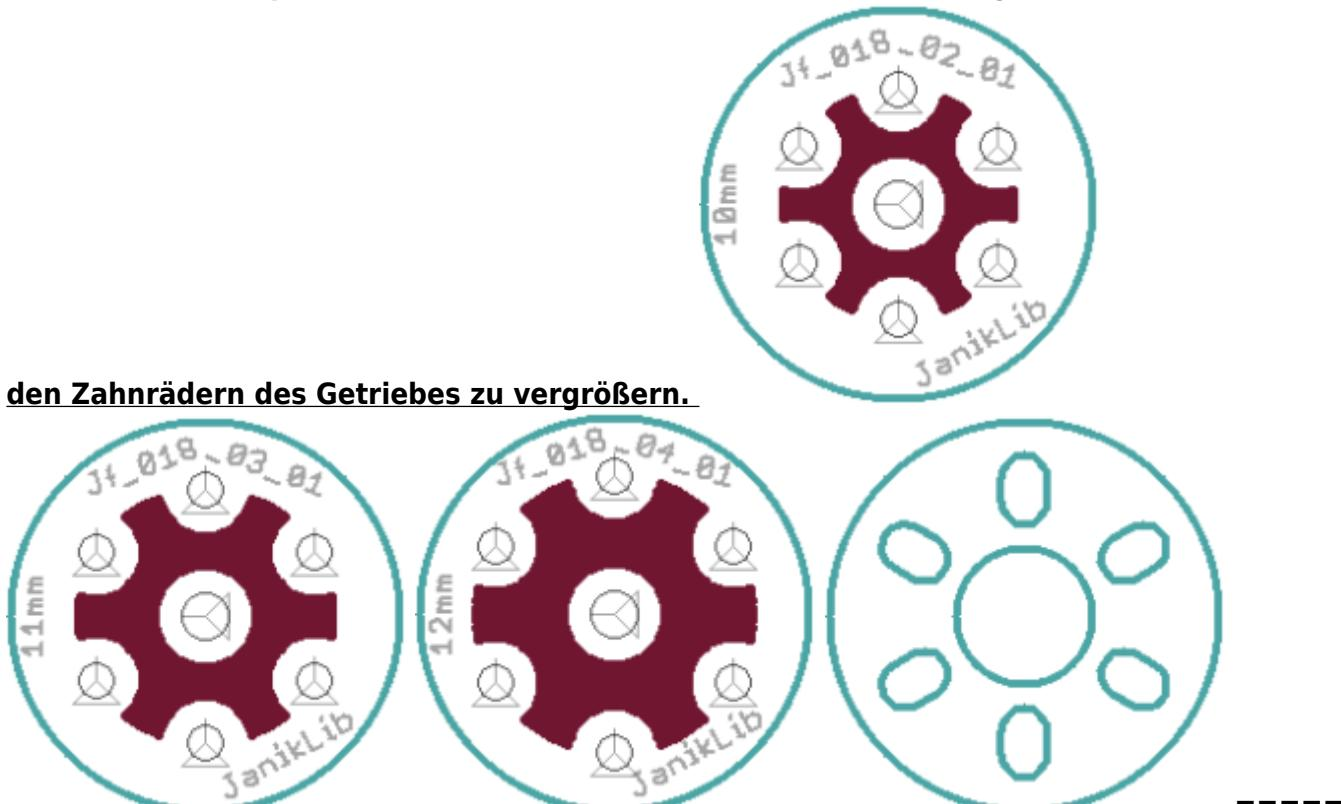
**Platinenherstellung ===== Bei den Bohrschablonen-Platten empfehle ich als Platinenmaterial Aluminium, da die Schablonen dann wahrscheinlich länger halten werden. Bei den Distanzplatten kann man entweder mehrere verschiedene Dicken bestellen, oder wie ich nur 0,5mm und bei Bedarf mehrere verwenden. ===== Kompatible Loks ===== Umbauen kann man alle Loks, in denen die alten Motoren mit Stirnrad Getriebe (Scheibenkollektor klein, groß, Trommelkollektor, HLA) verbaut sind.**
