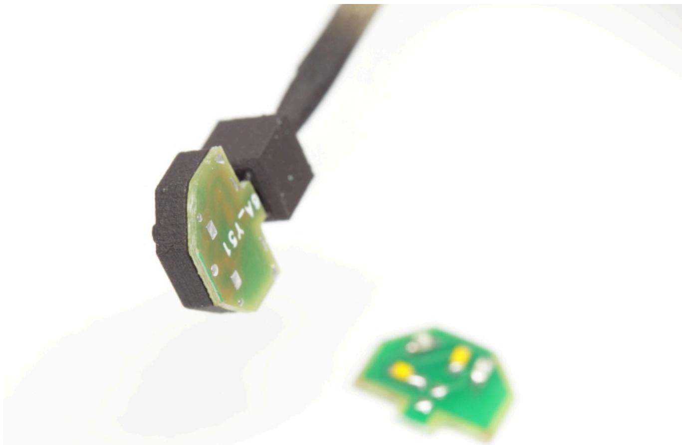
Der Steg, an dem oben die beiden Platinen gehalten werden, kann entweder wie hier teilweise stehen bleiben, oder komplett entfernt werden.
