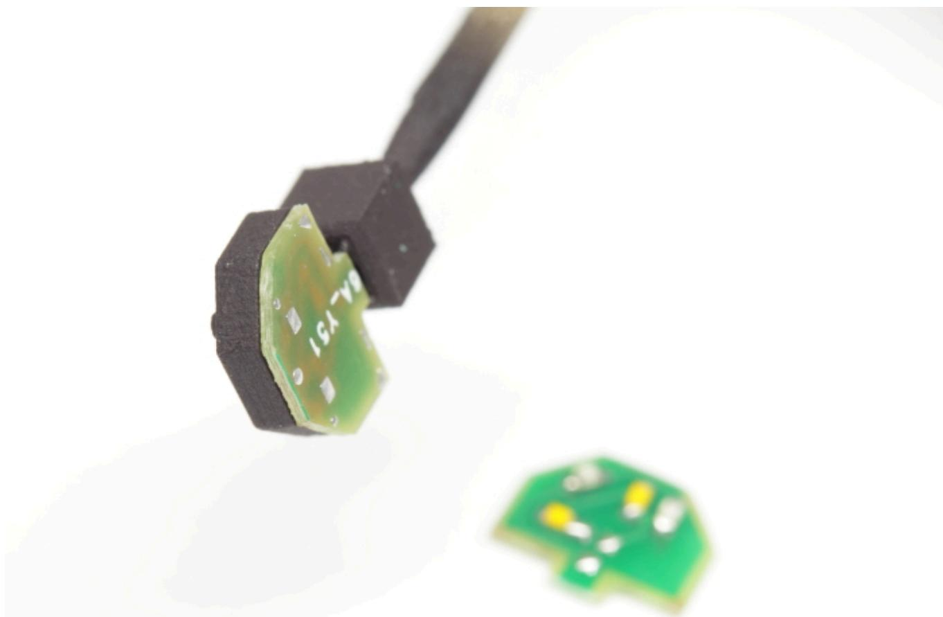
Der Steg, an dem oben die beiden Platinen gehalten werden, kann entweder wie hier teilweise stehen bleiben, oder komplett entfernt werden.
