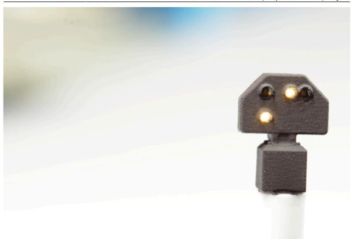
Ich habe die Signale auf 4mm Polystyrol Rohre geklebt. Später werde ich auf der Anlage das passende Gegenstück (4mm Bananen-Buchsen) verbauen.
