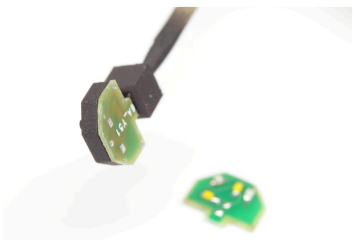
Der Steg, an dem oben die beiden Platinen gehalten werden, kann entweder wie hier teilweise stehen
