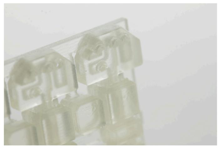
Die einzelnen Signale habe ich mit einem Skalpell vorsichtig vom Träger Rahmen entfernt. In den Signalen sind manchmal noch Hart-Reste, die ich mit dem Skalpell heraus gekratzt habe. Anschließend können die Kanten (bei Bedarf) noch entgratet werden, das war bei mir nur bei zwei der
