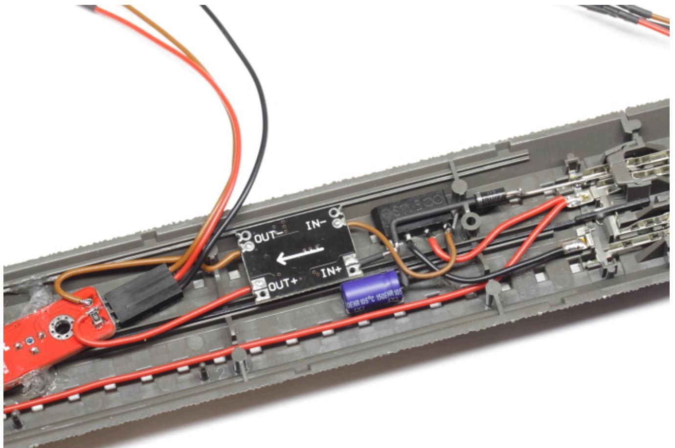
Die Messplatine wird hier über eine der beiden Sensor-Leitungen mit 5V versorgt.
