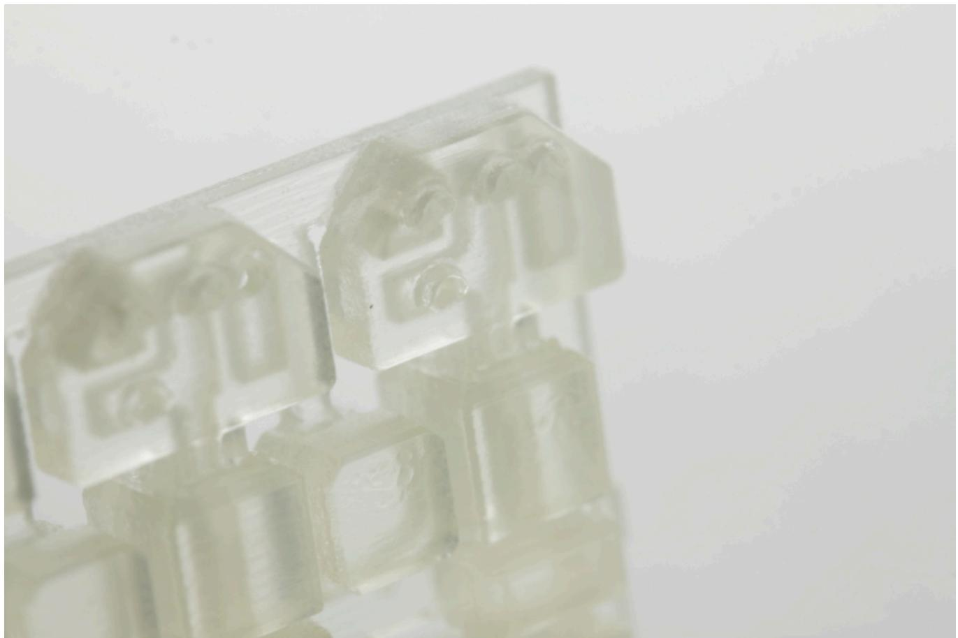
Die einzelnen Signale habe ich mit einem Skalpell vorsichtig vom Träger Rahmen entfernt. In den Signalen sind manchmal noch Hart-Reste, die ich mit dem Skalpell heraus gekratzt habe. Anschließend können die Kanten (bei Bedarf) noch entgratet werden, das war bei mir nur bei zwei der zehn Signalen nötig.
