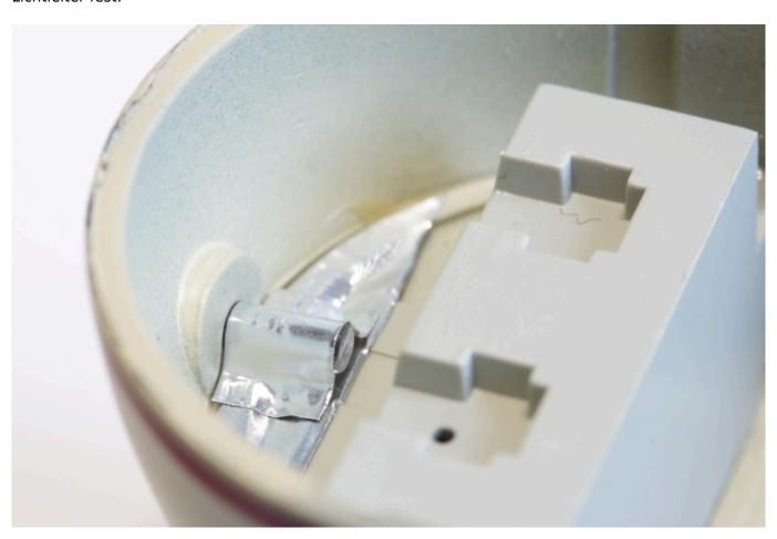
Damit der Führerstand von den moderneren 103ern passt, habe ich die Platine noch mit einer Zwischenplatte weiter nach vorne eingeklebt:
