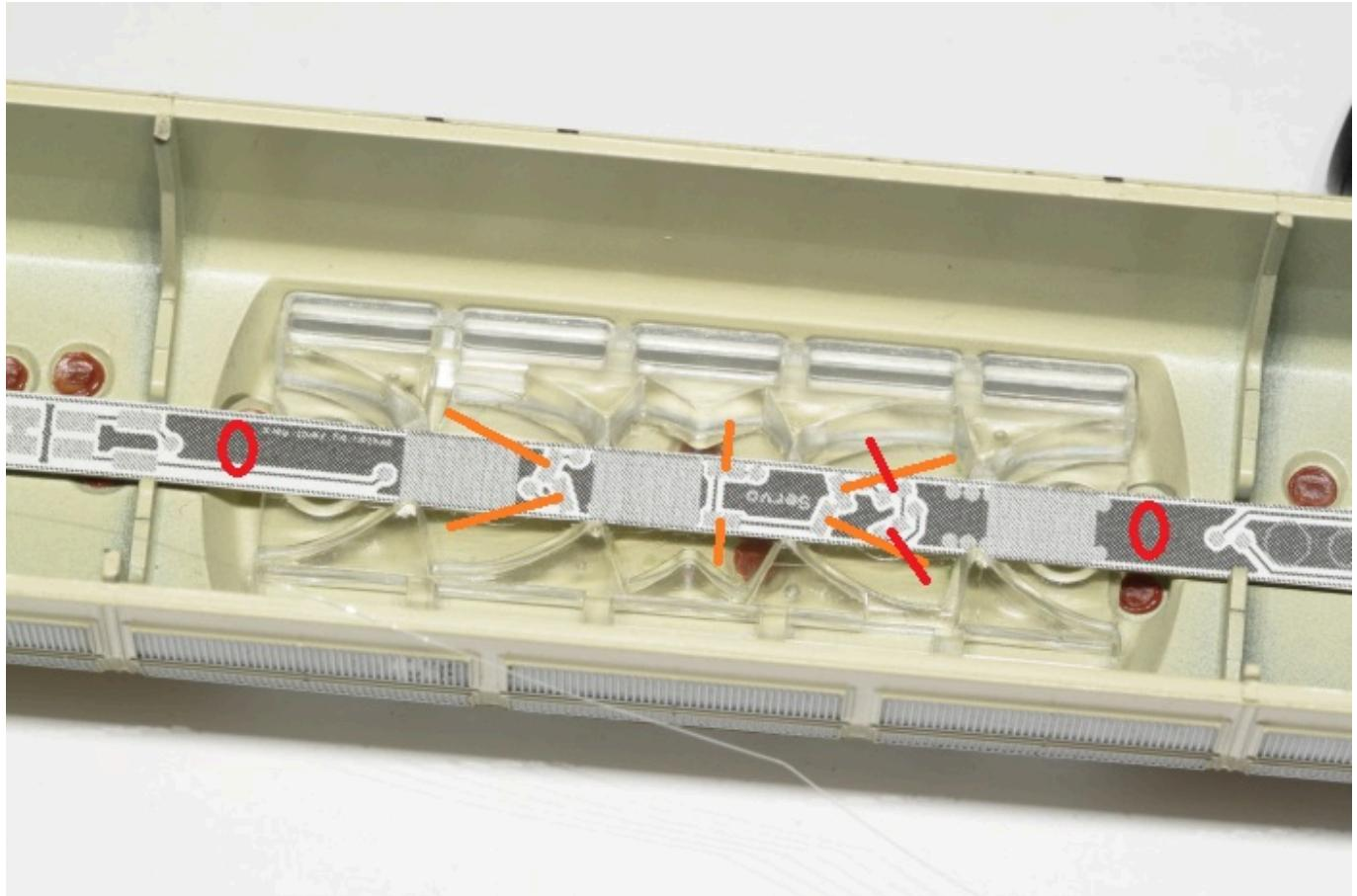
Die beiden roten LEDs auf der Rückseite sind normal flach eingelötet.
