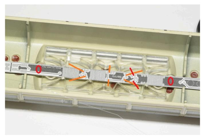
Die beiden roten LEDs auf der Rückseite sind normal flach eingelötet. Alle anderen LEDs sind seitlich gekippt und leuchten in die eingezeichneten Richtungen.
