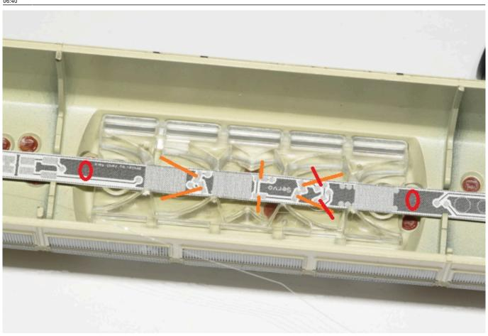
Die beiden roten LEDs auf der Rückseite sind normal flach eingelötet. Alle anderen LEDs sind seitlich gekippt und leuchten in die eingezeichneten Richtungen.
