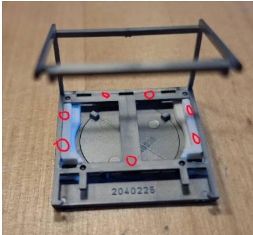
In die vier zuvor gebohrten 0,8mm Bohrungen werden nun jeweils ein Stück Lichtleiter gesteckt. Der Lichtleiter muss auf eine Länge von 2,5-3mm zugeschnitten werden. Hierzu ein Cuttermusser verwenden. Wenn man den Lichtleiter mit einem Seitenschneider abschneidet (auch mit den kleinen Modellbauseitenschneidern), kann er aufspleissen
