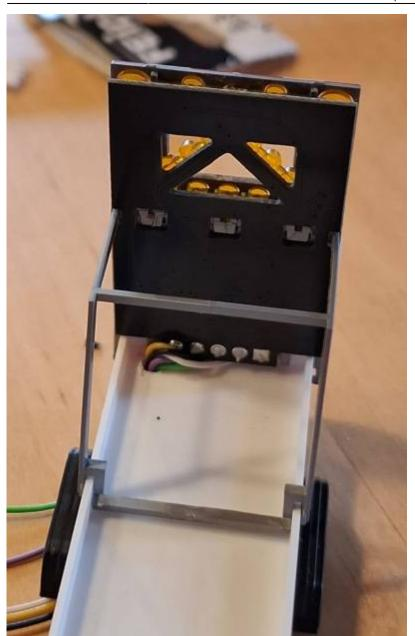
Um die Kabel zu verstecken muss durch den Anhänger ein 2,5mm Loch gebohrt werden. Dadurch passen die fünf Kabel leicht durch. Ich verwende Microlitze mit 0,05mm². Diese Kabel sind noch ausreichend dick, für die Spannungsversorgung, aber trotzdem biegsam und flexibel. Der Bohrer wird bündig am grauen Rahmen angesetzt und durchgebohrt.
