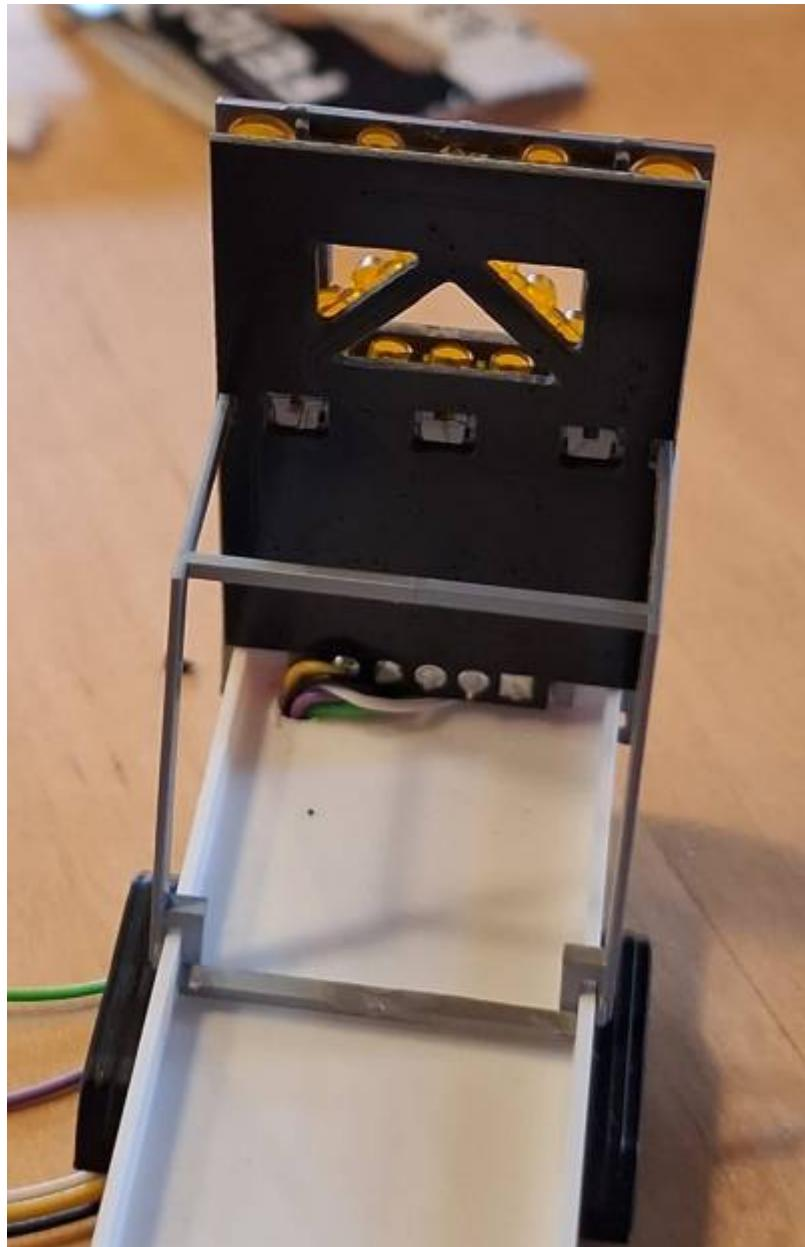
Um die Kabel zu verstecken muss durch den Anhänger ein 2,5mm Loch gebohrt werden. Dadurch passen die fünf Kabel leicht durch. Ich verwende Microlitze mit 0,05mm<sup>2</sup>. Diese Kabel sind noch ausreichend dick, für die Spannungsversorgung, aber trotzdem biegsam und flexibel. Der Bohrer wird bündig am grauen Rahmen angesetzt und durchgebohrt.
