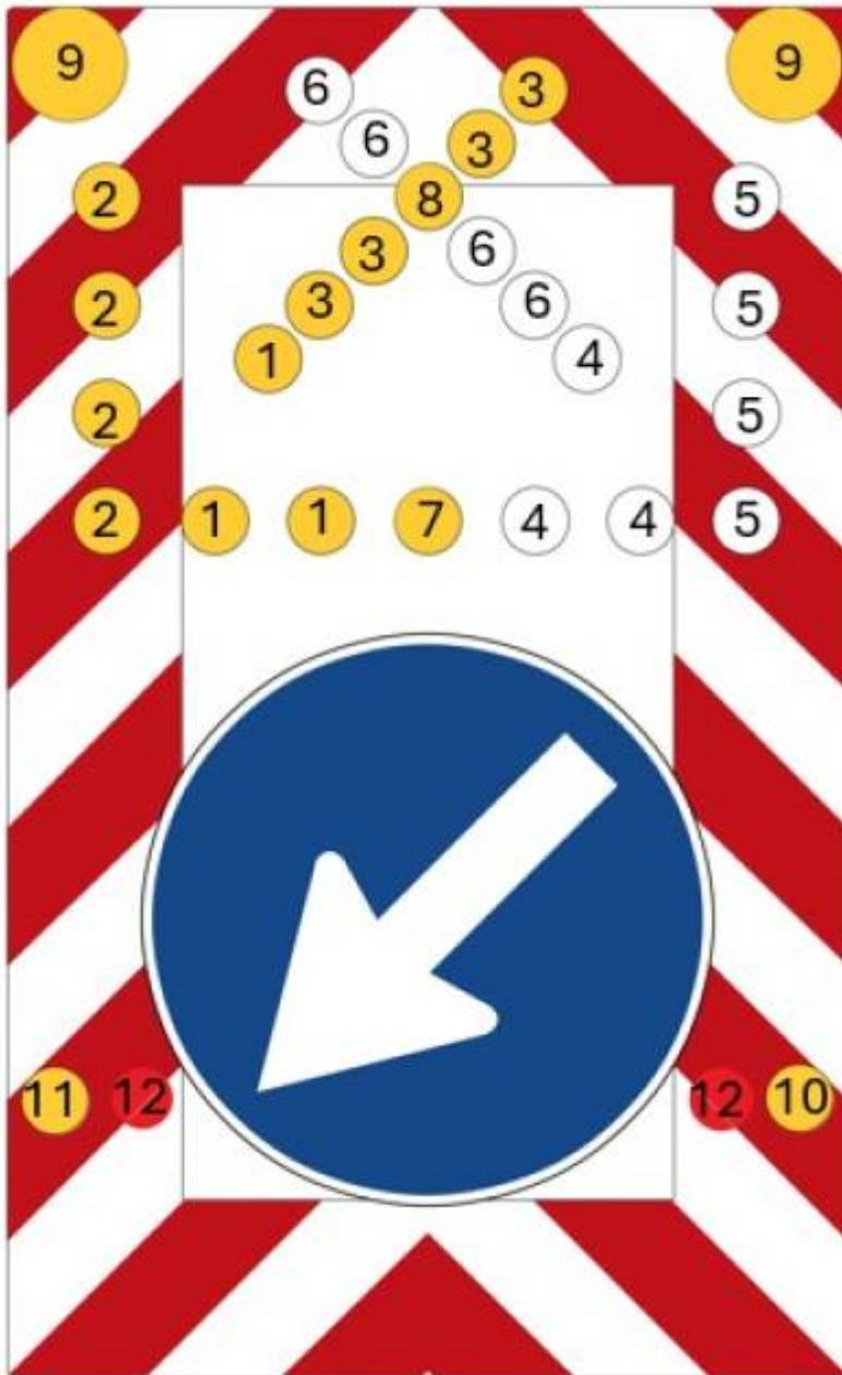
Die LEDs 1-6 arbeiten mit 12V, die LEDs 7-12 arbeiten mit 5V.
