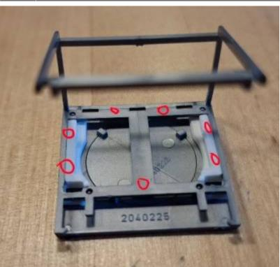
In die vier zuvor gebohrten 0,8mm Bohrungen werden nun jeweils ein Stück Lichtleiter gesteckt. Der Lichtleiter muss auf eine Länge von 2,5-3mm zugeschnitten werden. Hierzu ein Cuttermusser verwenden. Wenn man den Lichtleiter mit einem Seitenschneider abschneidet (auch mit den kleinen Modellbauseitenschneidern), kann er aufspleissen Danach hat man vier kleine Stücke:
