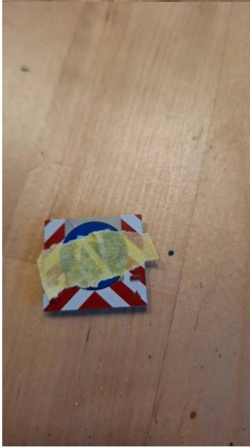
Jetzt wird die Platine aufgeklebt. **Dazu unbedingt wieder den oberen Teil mit dem Leuchtpfeil aufsetzen, später lässt er sich nicht mehr montieren.** Die Platine wird dann auf den Rahmen aufgeklebt, hierbei reichen ein paar Klebepunkte Sekundenkleber. Bitte nur ganz wenig auftragen:
