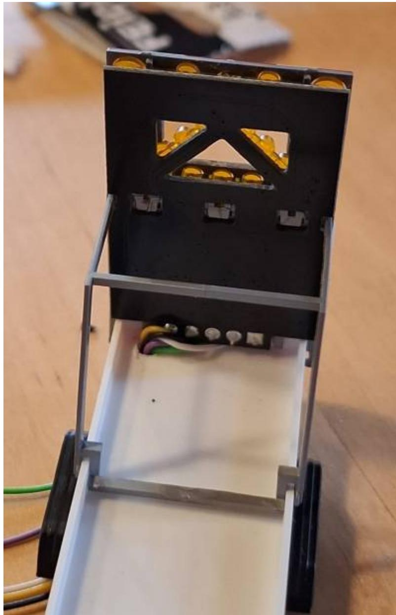
Um die Kabel zu verstecken muss durch den Anhänger ein 2,5mm Loch gebohrt werden. Dadurch passen die fünf Kabel leicht durch. Am besten verwendet man Microlitze mit  $0,05\text{mm}^2$ . Diese Kabel sind noch ausreichend dick für die Spannungsversorgung, aber trotzdem biegsam und flexibel. Der Bohrer wird bündig am grauen Rahmen angesetzt und durchgebohrt.
