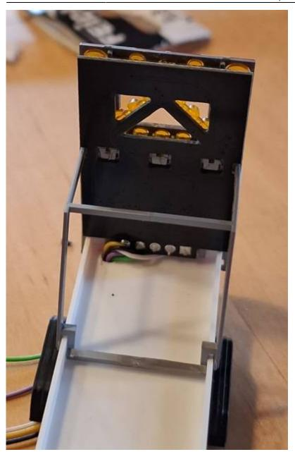
Um die Kabel zu verstecken muss durch den Anhänger ein 2,5mm Loch gebohrt werden. Dadurch passen die fünf Kabel leicht durch. Am besten verwendet man Microlitze mit 0,05mm². Diese Kabel sind noch ausreichend dick für die Spannungsversorgung, aber trotzdem biegsam und flexibel. Der Bohrer wird bündig am grauen Rahmen angesetzt und durchgebohrt.
