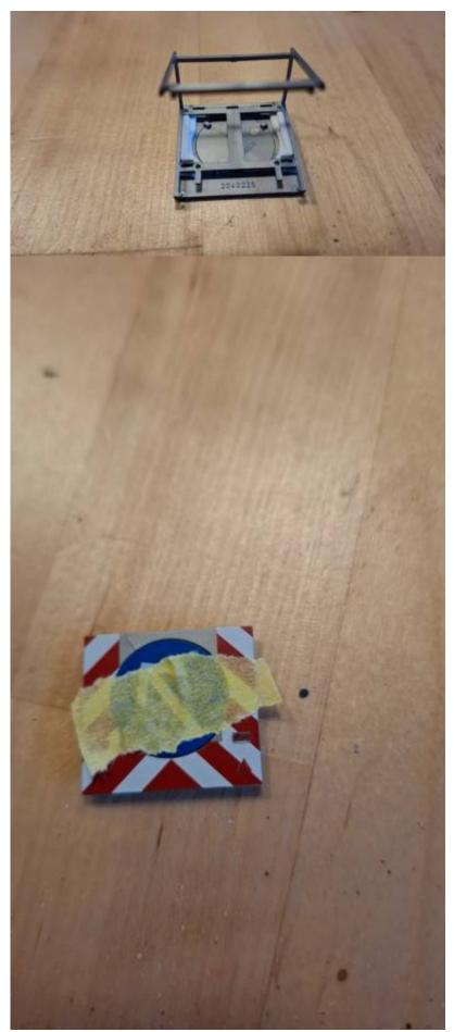
Jetzt wird die Platine aufgeklebt. **Dazu unbedingt wieder den oberen Teil mit dem Leuchtpfeil aufsetzen, später lässt er sich nicht mehr montieren**. Die Platine wird dann auf den Rahmen aufgeklebt, hierbei reichen ein paar Klebepunkte Sekundenkleber. Bitte nur ganz wenig auftragen:
