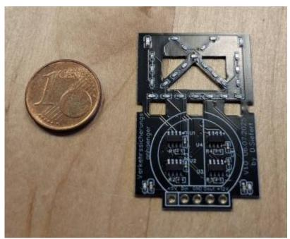
Die Platine ist SMD vorbestückt und hat 28 gelbe und zwei rote LEDs. Diese werden mit nur vier WS2811 angesteuert. Dazu war dann allerdings eine zweite Spannungsebene nötig, um bis zu vier gelbe LEDs in Reihe zu schalten. Daher gibt es fünf Anschlüsse +5V, Din, GND, Dout, +12V. Um die LEDs im Programmgenerator bzw. im PatternConfigurator ansteuern zu können, muss man wissen, welche LED (oder LEDs) in welcher Reihenfolge auf der Platine sitzen. Daher gibt es hier das Anschlusschema der LEDs:
