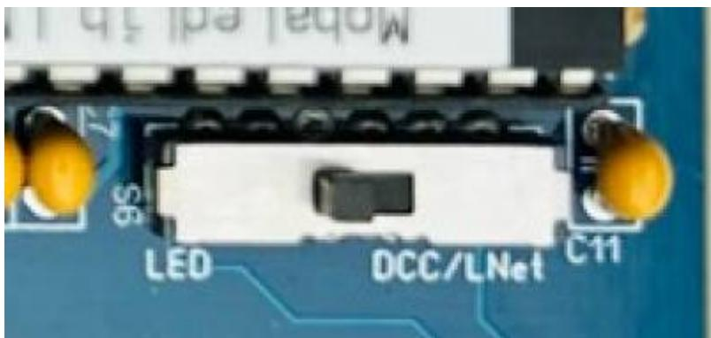
**S6 darf nur verschoben werden, wenn die FTDI-Schnittstelle von der MLL-Anwendung getrennt ist!**
