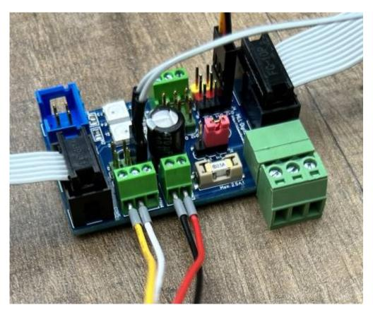
Beide Relais können ebenso wie die Heartbeats von Ausgang 1 (LED-Kanal 0) und 2 (LED-Kanal 1) sowie die Return-Beats mit DCC-Befehlen oder vom Program Generator aus gesteuert werden.
