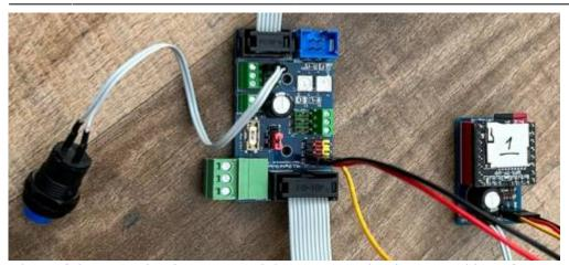
Hier auf dem Foto ist das MP3-Modul an D12 sowie einen Druckknopf an D7 mit dem MLL Digital Output-Modul verbunden
