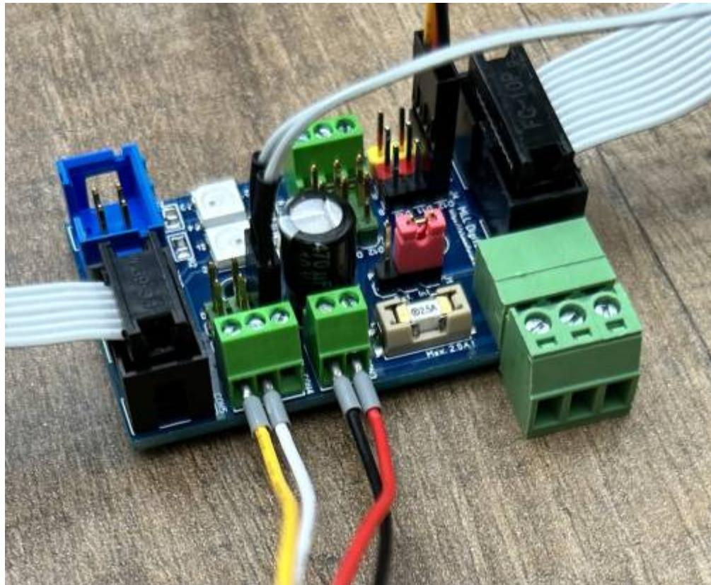
Beide Relais können ebenso wie die Heartbeats von Ausgang 1 (LED-Kanal 0) und 2 (LED-Kanal 1) sowie die Return-Beats mit DCC-Befehlen oder vom Program Generator aus gesteuert werden.
